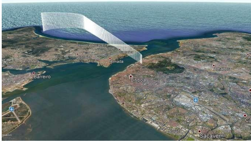
Figura 4.7: Trajetória de descida a partir do ponto de falha, situação 1
