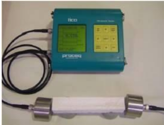
Figura 3.14- Equipamento TICO Proceq em funcionamento.
