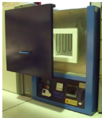
Figura 3.8 - Mufla Termolab utilizada na sinterização dos corpos de prova.
