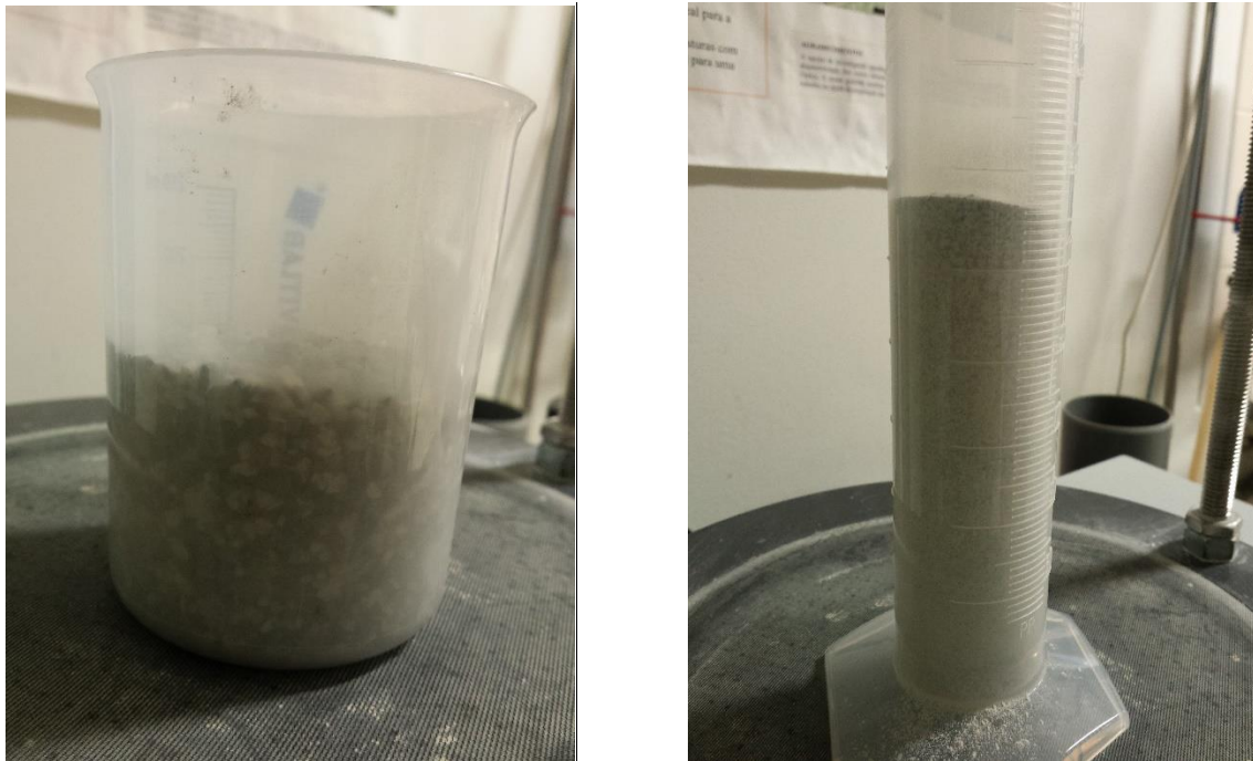
Figura A.1 - Resultado da separação por vibração: a) Recipiente (diâmetro 70mm) com resíduo refratário após a separação; b) Recipiente (diâmetro 40mm) com resíduo refratário após a separação.
