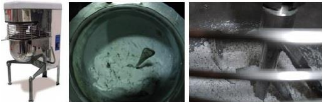
Figura 3.6 - Procedimento de mistura: a) misturadora Tecnotest modelo B205/X5 [ref google]; b) mistura no estado seco; c) homogeneização da mistura húmida [40].
