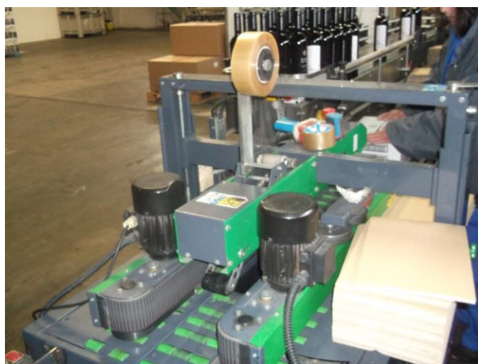
Figura 4.16. Máquina rotativa adesiva (máquina de fechar caixas)
