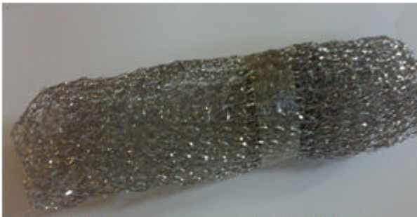
Fig.15. Malha em aço porosa (material1)
