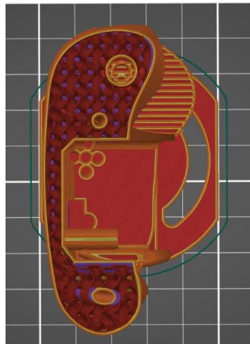
Fig.27. Padrão gyroid usado no infill do modelo (representado pela cor vermelho-escuro).
