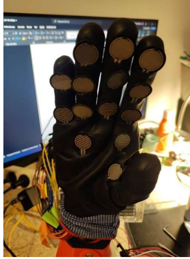
Fig.63. Definição da ordem de ligação dos sensores piezoresistivos. Ao lado esquerdo a representação esquemática dos sensores, ao lado direito a representação da luva protética já montada.
