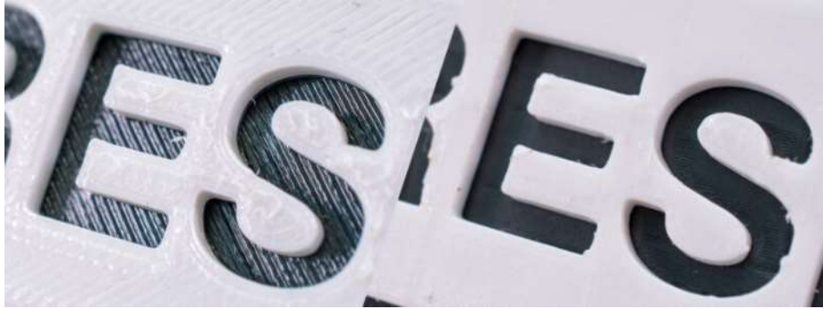
Fig.29. Demonstração da impressão sem usar o processo de ironing (lado esquerdo) e ao usar o processo de ironing (lado direito).
