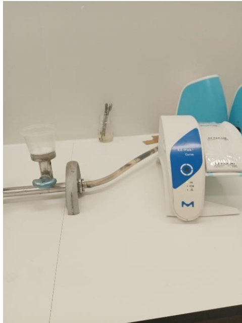
Figura 13. Filtração de 100 mL de ACH através de uma membrana de porosidade 0,45\text{ }\mu\text{m} numa rampa de filtração estéril.
