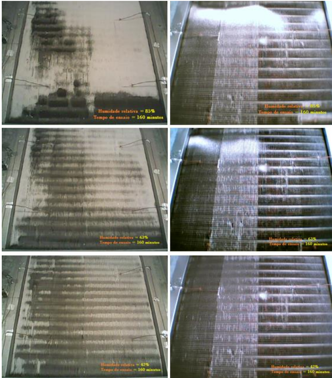
Figura 4.9 Superfície Frontal e Traseira do permutador de calor nos três ensaios de variação de umidade realizados aos 160 minutos do ciclo de congelamento.
