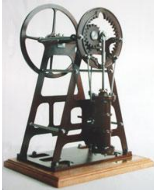
Figura 9. Réplica do modelo de máquina a vapor com sistema hipocicloide de Matthew Murray (Davey, 2008).
