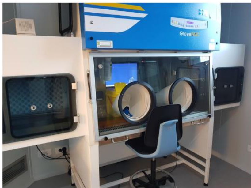
Figura 3 - Isolador dos SF do Hospital CUF Porto
