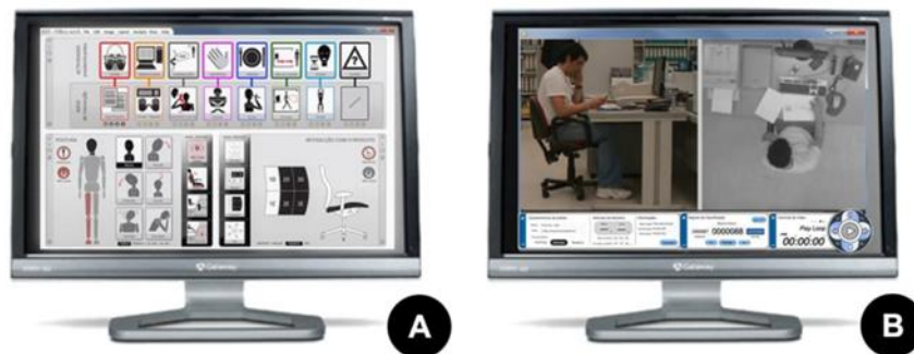
Imagem 31 Arranjo por defeito das janelas em dois monitores. No monitor A ficam contidas as categorias de análise e no monitor B a janela de vídeo e o seu controlador. (Filgueiras, 2011)
