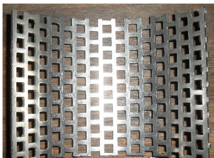
Figura 19 - Crivo com abertura de 10 mm.
