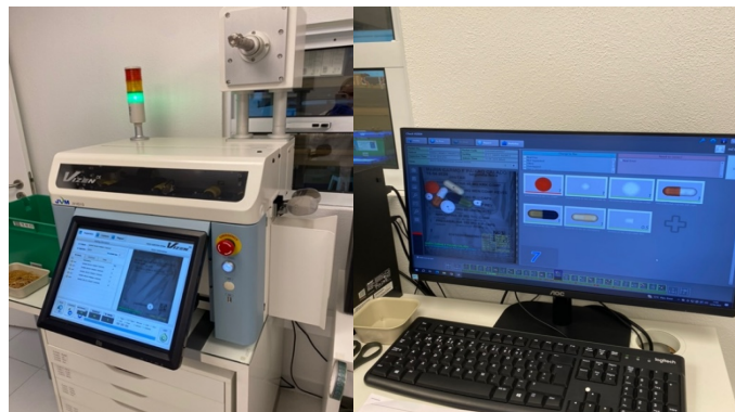
Figura 11 - Sistema fotográfico de verificação de erros e verificação das fotos de cada saqueta por um farmacêutico.
