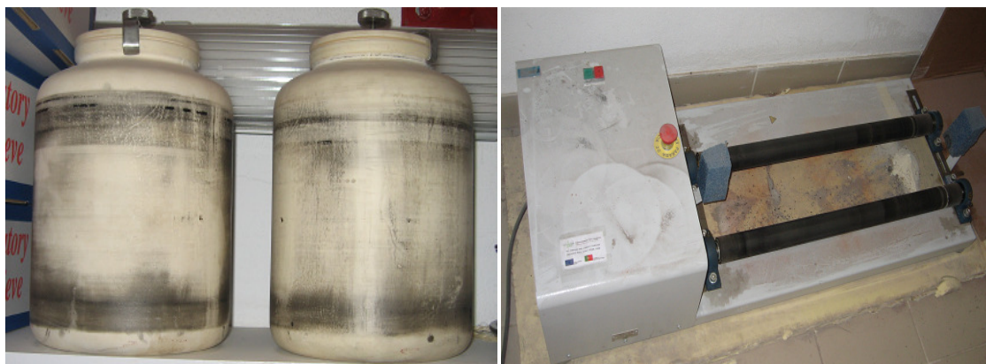
Figura 9: Esquerda: Recipientes cerâmicos de moagem da pozolana de vidro Direita: Máquina onde se colocam os recipientes para moagem
