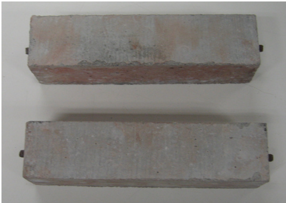
Figura 12: Corpos-de-prova das barras prismáticas (40x40x160 mm)
