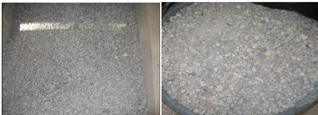
Figura 10: Esquerda: Agregado grosso granítico direita: Agregado grosso reactivo
