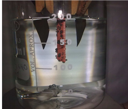
Figura 5.5 - Redução do cobre (II) sobre aço, após duas horas e meia de aplicação de potencial (-500 mV) em 200 mL de uma solução ( \text{CuSO}_4 1 \times 10^{-2} M + \text{Na}_2\text{SO}_4 0,035 M), a pH=3,5.
