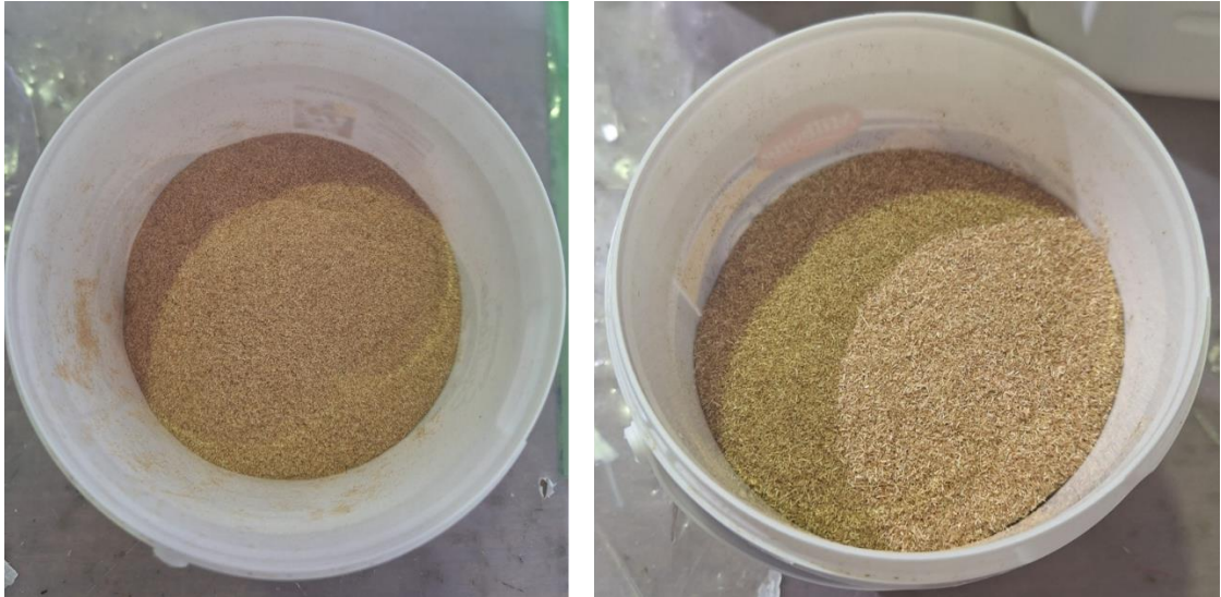
Figura 25 - Partículas de madeira obtidas após peneiração a seco: 0,15 mm e 0,3 mm.
