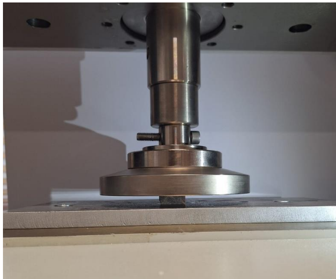
Figura 41 – Posição do provete nos ensaios de compressão horizontal.
