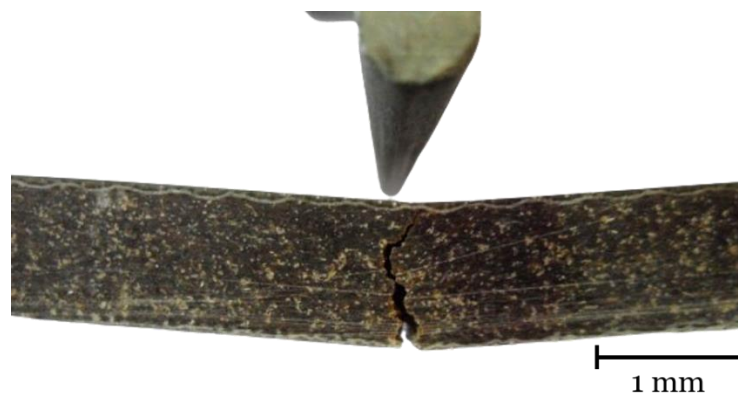
Figura 51 – Danos típicos verificados nos ensaios de flexão em três pontos da sanduíche.
