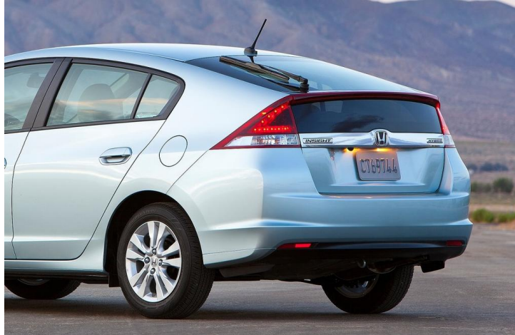
Figura 5 - Modelo que utiliza a solução "traseira "Kammback".
