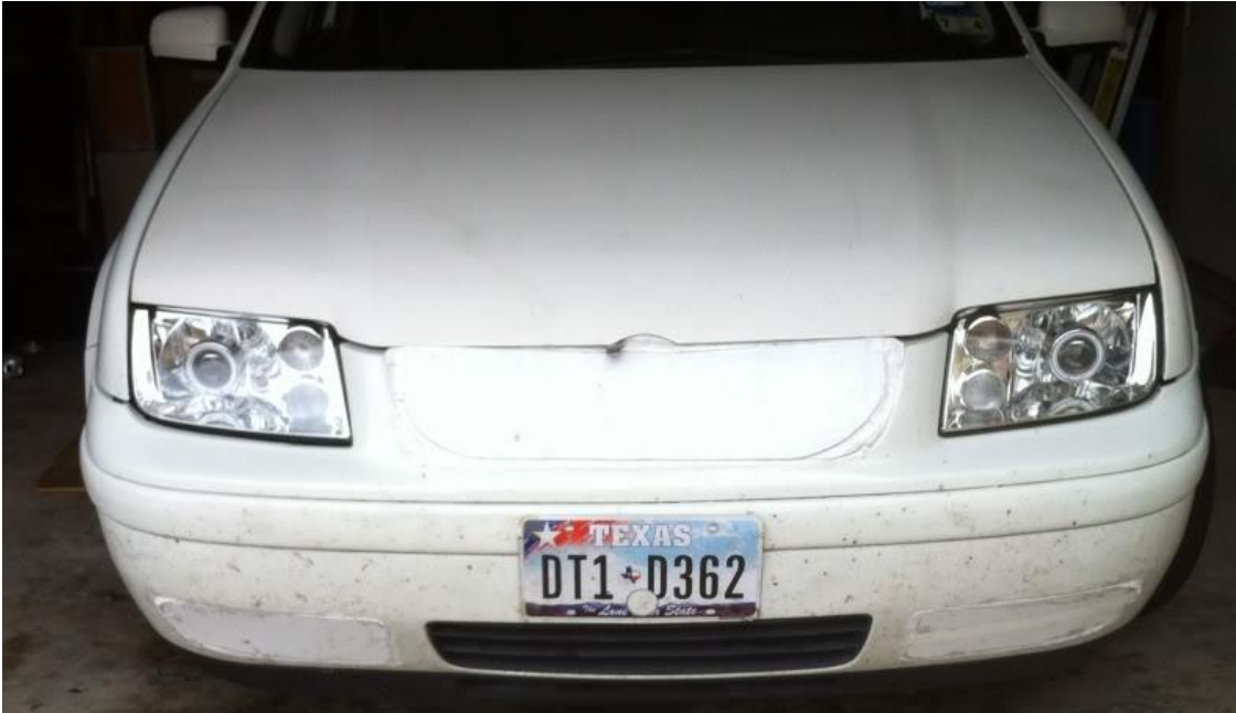
Figura 4 - Estratégia Eco Car Tuning, cobertura das entradas de ar frontais
