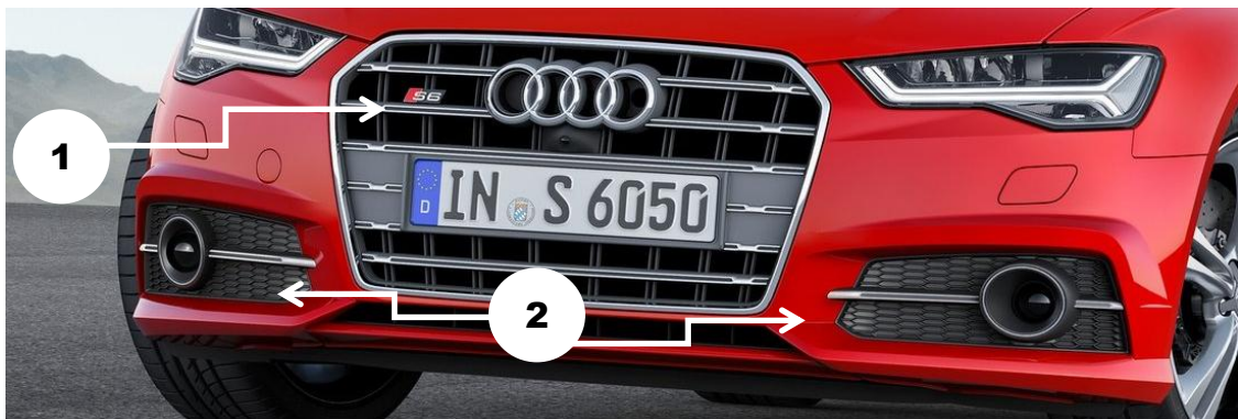
Figura 3 - Automóvel com entradas de ar frontais verdadeiras (1) e falsas (2).
