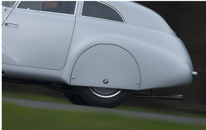
Figura 9 - Automóvel com as cavas de rodas traseiras cobertas.
