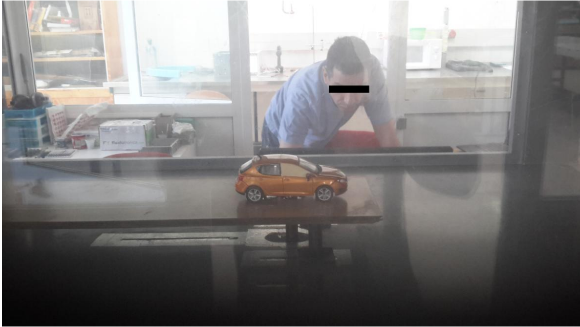
Figura 26 - Ensaio em túnel de vento físico.
