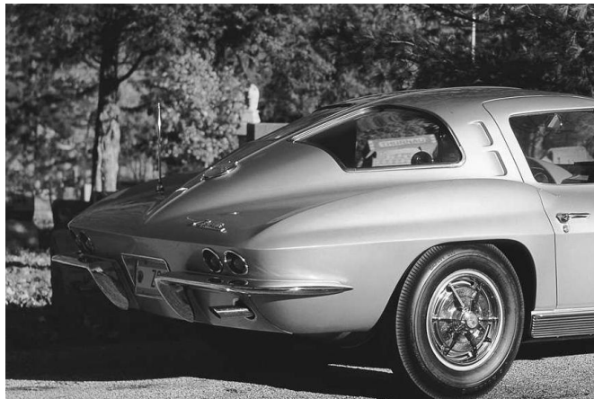
Figura 7 - Veículo que apresenta uma traseira com a forma “boatend”.
