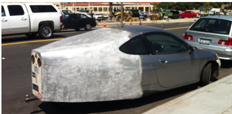
Figura 8 - Exemplo de estratégia Eco Car Tuning, traseira “Boatend”.
