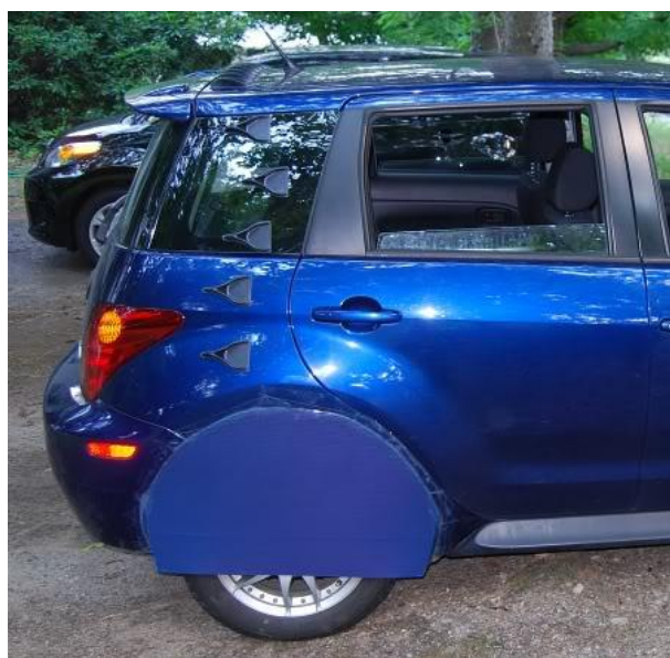
Figura 10 - Exemplo de estratégia Eco Car Tuning, cobertura das cavas de rodas traseiras.
