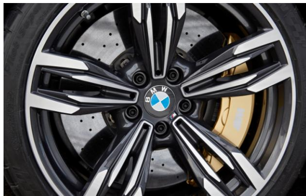
Figura 11 - Jantes de carros de alta cilindrada com grandes aberturas para refrigeração do sistema de travagem em altas velocidades.
