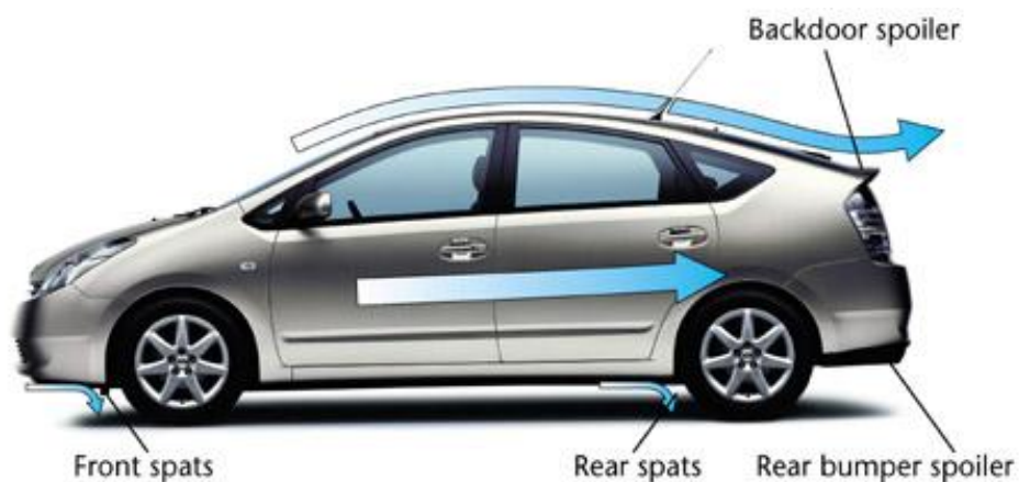
Figura 14 - Estratégias para otimização aerodinâmica do Toyota Prius.
