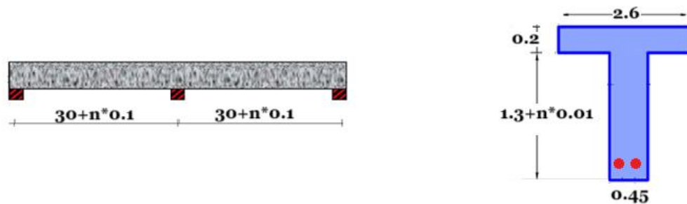
Figura 4.1 - Viga contínua. Exemplo de aplicação prática.
