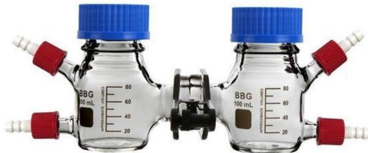
Figura 2.2 - Modelo MFC tipo H.
