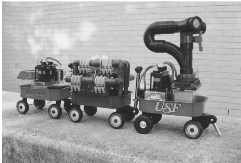
Figura 2.9 - Gastronome, um protótipo de robô alimentado por célula de combustível microbiana [31].
