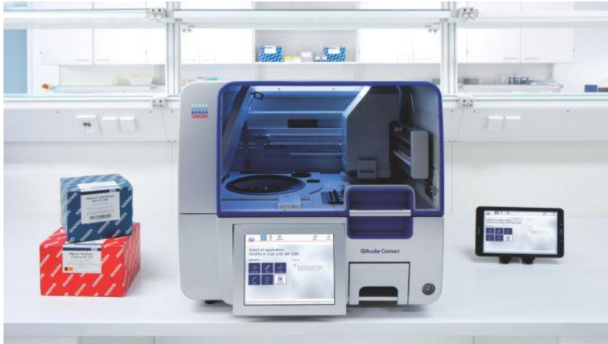
Figura 33. Equipamento automatizado de extração de ácidos nucleicos com utilização de colunas de sílica, QIAcube Connect (Qiagen)
