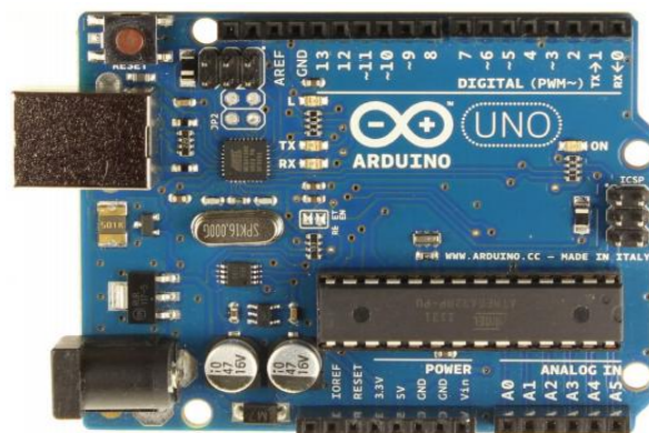
Figura 4 - Placa Arduino UNO R3 (retirado de Lima et al. (2021)).
