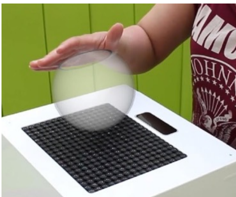
Figura 21 Dispositivo háptico ultrassónico. Fonte: Youtube.
