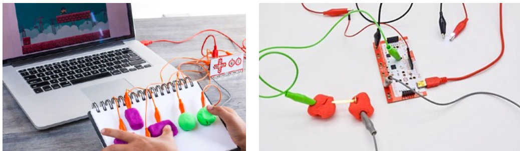
Figura 23 Makey Makey é um exemplo de uma interface tangível. Fonte: Kitronik.
