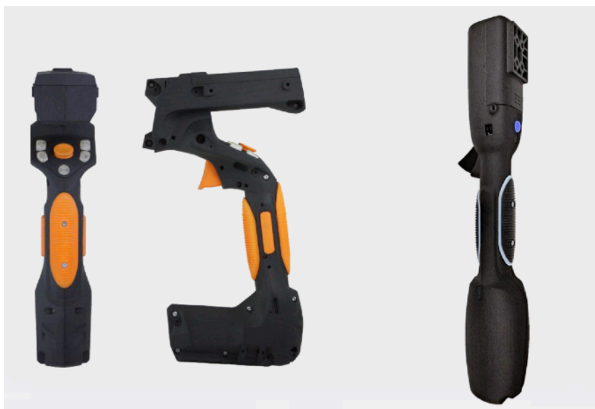
Figura 33 Reactive Grip , controlador de movimento capaz de emitir feedback háptico, através de força e movimento. Fonte: Tactical haptics.
