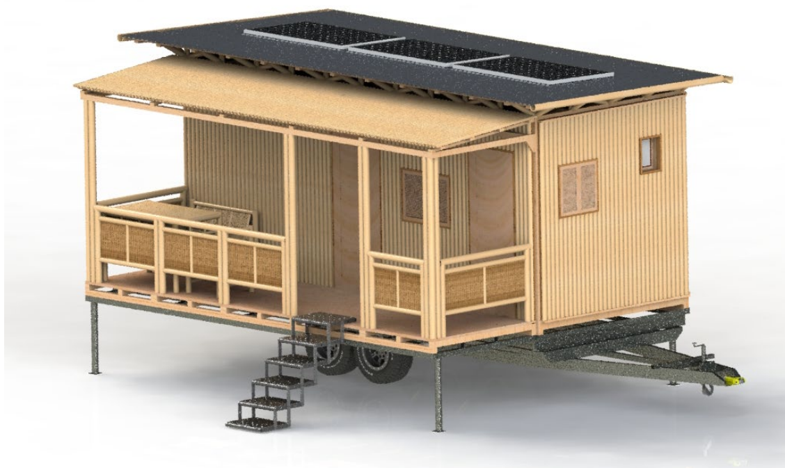
Figura 78: Renderização 3D - Vista em perspectiva do módulo com a montagem de varanda concebido com materiais locais (Paredes em bambu, estrutura em madeira).
