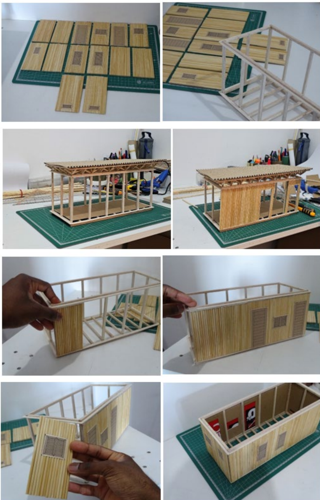
Figura 83: Construção de maquete – Conceção e aplicação de paredes exteriores do módulo em bambu e aplicação de portas e janelas.
