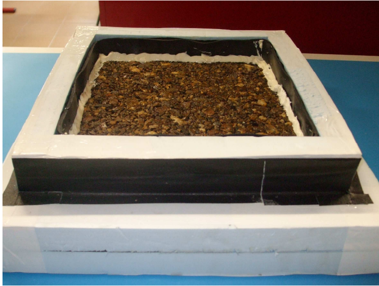
Figura G.2: Provede preparado para o Ensaio de Resistência ao Gelo/Degelo
