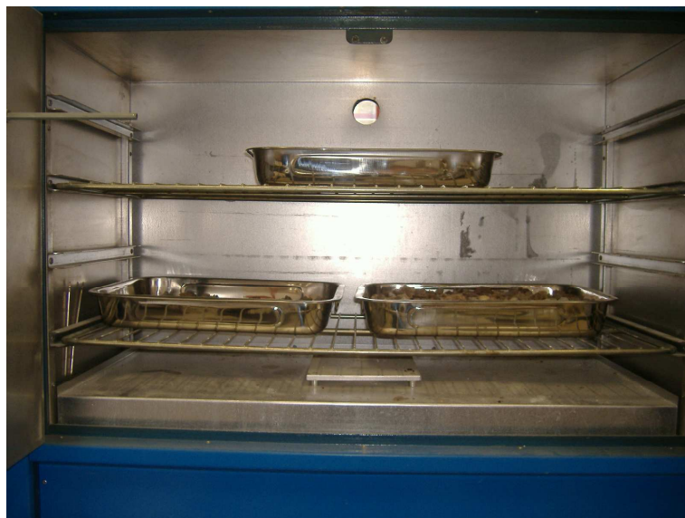
Figura B.6: Secagem do resíduo grosso na estufa
