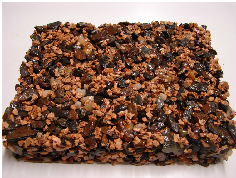
Figura 4.3: Provete composto por resíduos grossos das escombri- ras das Minas da Panasqueira, granulos de cortiça e resina de poliéster
