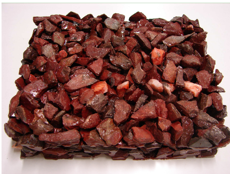
Figura 4.1: Provete sem brilho superficial composto por Resíduos Grossos das Escombrireas das Minas da Panasqueira calcinados e Resina de Poliéster
