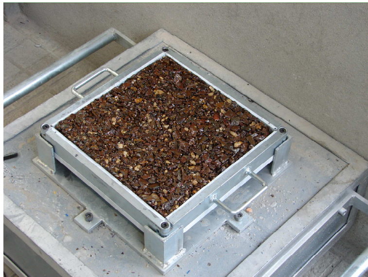
Figura 4.19: Cura do provete a temperatura ambiente
