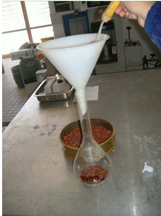
Figura B.1: Preparação do provete para imersão
