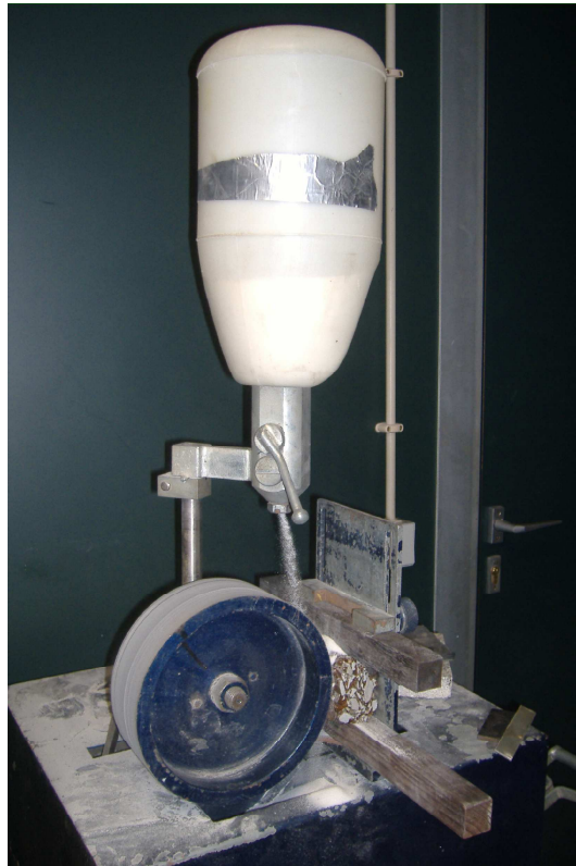
Figura E.1: Ensaio da Resistência ao Desgaste pelo Disco de Abrasão Largo
