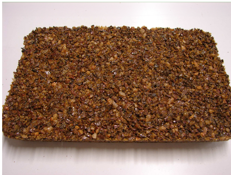
Figura 4.5: Provete composto por resíduos grossos das escombreliras das Minas da Panasqueira, agregados de mármore e resina de poliéster
