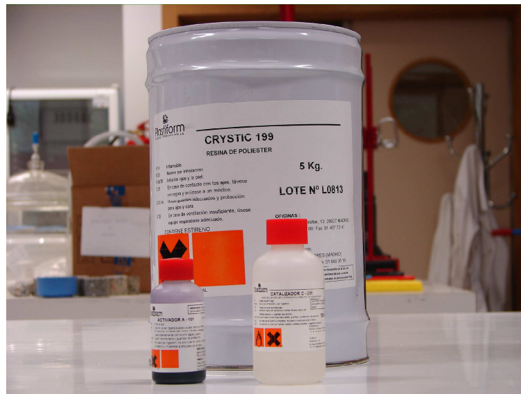
Figura 3.8: Resina Crystic 199, Activador A-101 e Catalisador C-201 empregados na realização dos provetes de ensaio
