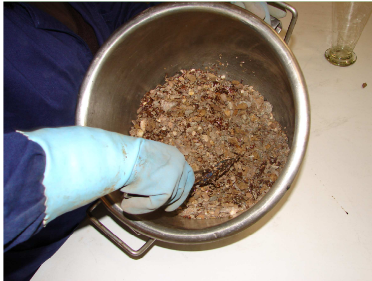
Figura 4.16: Mistura da Resina com o resíduo grosso
