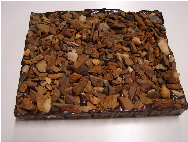
Figura 4.6: Provete composto por resíduos grossos e finos das escombreyras das Minas da Panasqueira e resina
