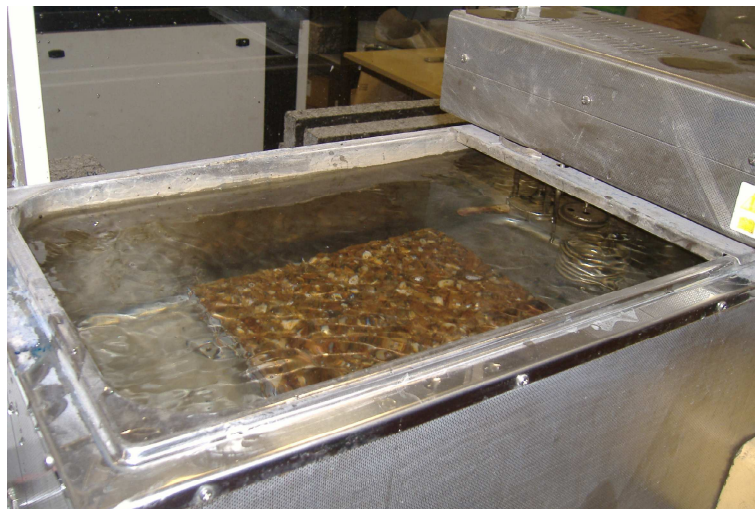
Figura F.1: Provete mergulhado em água a (20\pm 2)^{\circ}\text{C}
