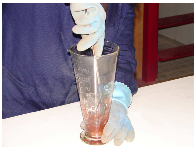
Figura 4.15: Mistura da Resina com o activador e catalisador
