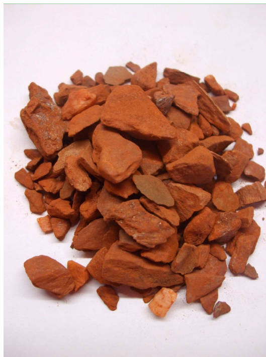
Figura 3.7: Resíduos grossos das Minas da Panasqueira de cor avermelhada
