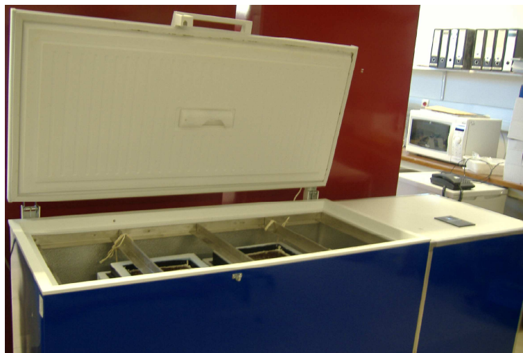
Figura G.4: Ensaio de Resistência ao Gelo/Degelo
