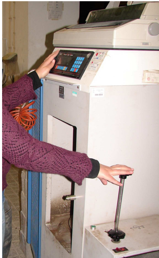
Figura D.2: Ensaio à compressão dos provetes
