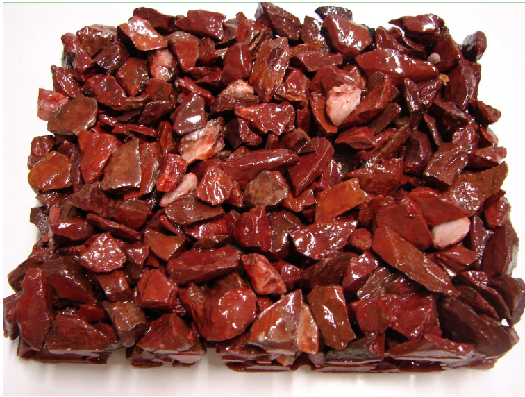
Figura 4.2: Provete com brilho superficial composto por Resíduos Grossos das Escombri- ras das Minas da Panasqueira calcinados e Resina de Poliéster
