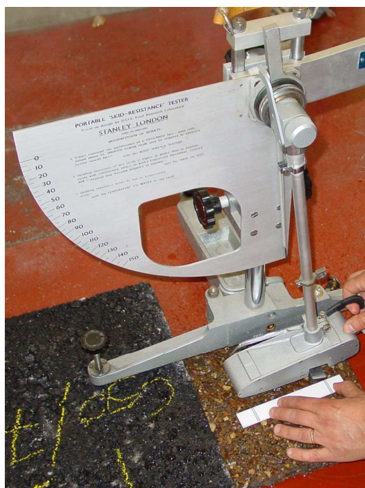
Figura F.3: Verificação do patim de borracha em contacto com o provete em toda a largura deste
