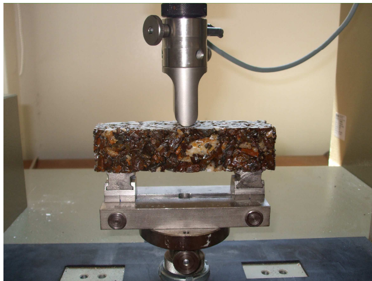
Figura C.2: Ensaio de Resistência à Flexão
