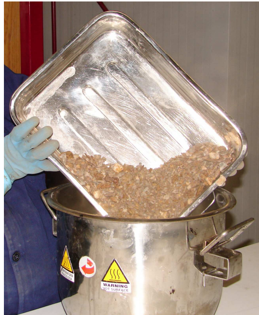
Figura 4.10: Colocação dos resíduos grossos da vasilha metálica de mistura
