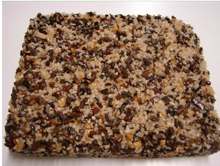
Figura 4.4: provete composto por resíduos grossos das escombreliras das Minas da Panasqueira, agregados de mármore e resina de poliéster
