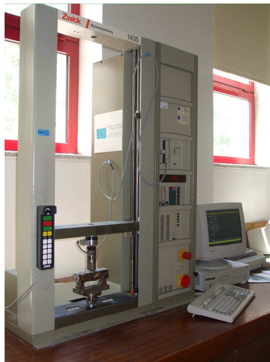
Figura C.1: Máquina de Ensaio Universal "ZWICK 1435", com Célula de Carga de 5kN e Velocidade de Teste 3mm/min
