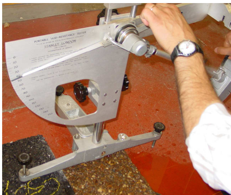
Figura F.4: Ensaio de Resistência ao Escorregamento/Deslizamento
