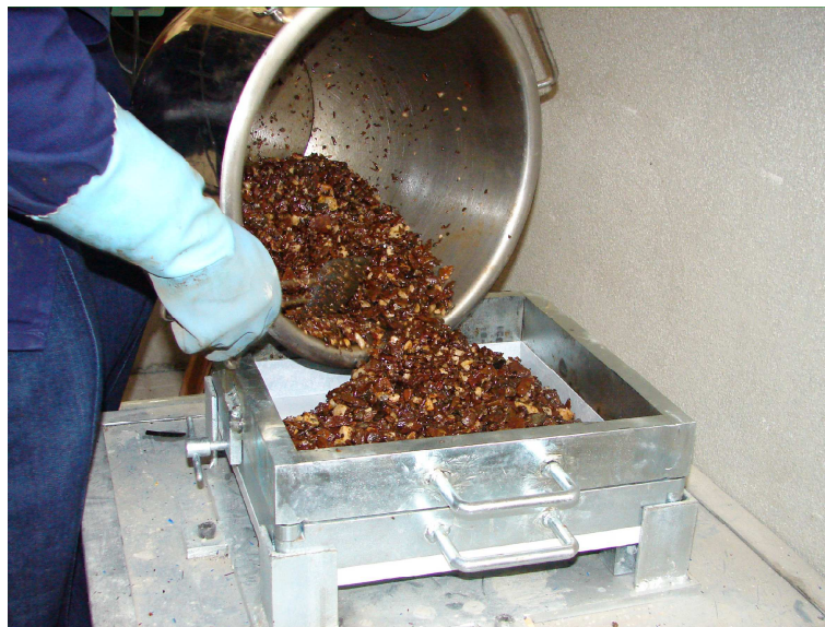
Figura 4.17: Transferência da mistura Resina e resíduos grossos para o molde de cura
