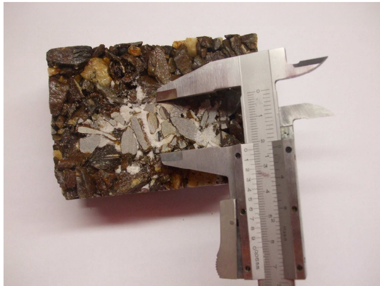
Figura E.3: Medição do sulco resultante do desgaste efectuado pelo Disco de Abrasão Largo
