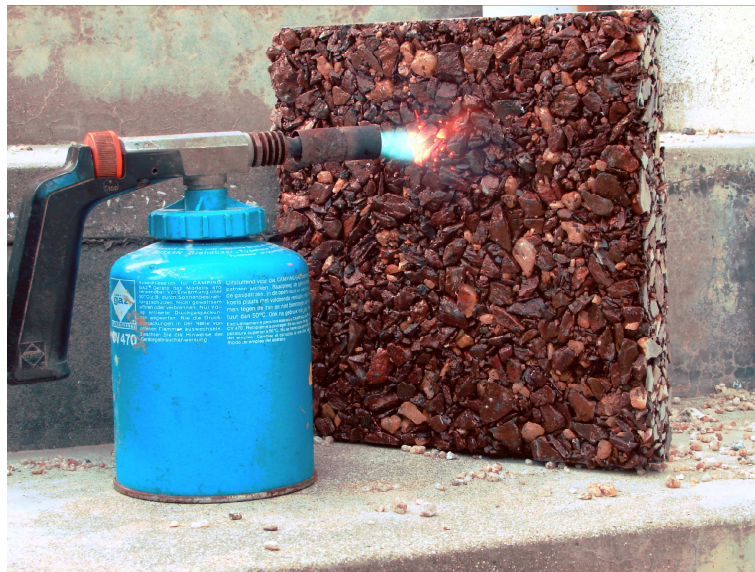
Figura H.1: Ensaio do provete ao Desempenho ao Fogo
