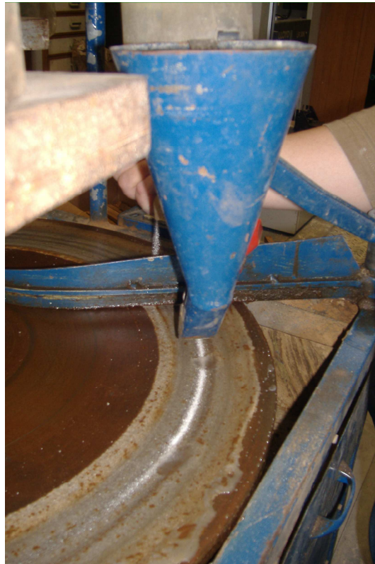
Figura E.5: Distribuição do Abrasivo na Pista de Ensaio pelo Método de Böhme
