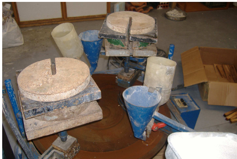
Figura E.6: Pista de Ensaio pelo Método de Böhme
