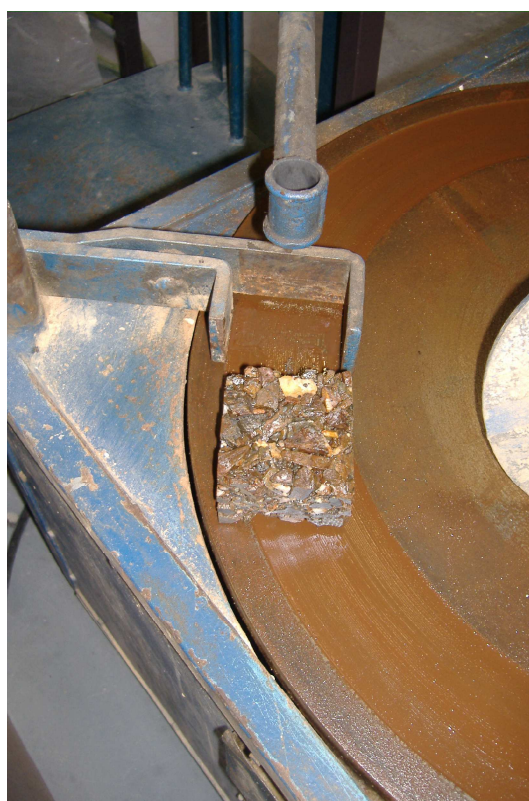
Figura E.4: Colocação do provete no Porta-Provetes
