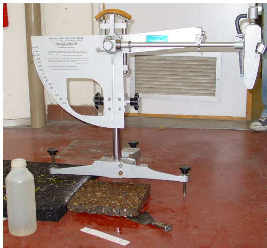
Figura F.2: Pêndulo de atrito e provete para ensaio de Resistência ao Escorregamento/Deslizamento
