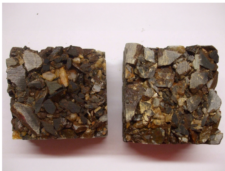
Figura E.7: Provetes desgastados após o ensaio pelo Método de Böhme
