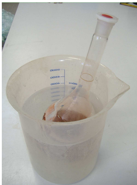
Figura B.3: Picnómetro com o provete em Banho-Maria
