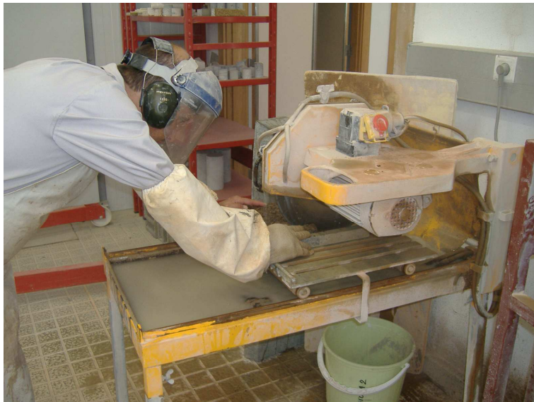
Figura 4.20: Corte dos provetes de ensaio
