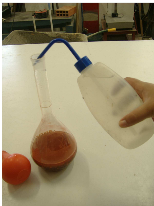
Figura B.4: Adição de água ao provete até transbordar o picnómetro
