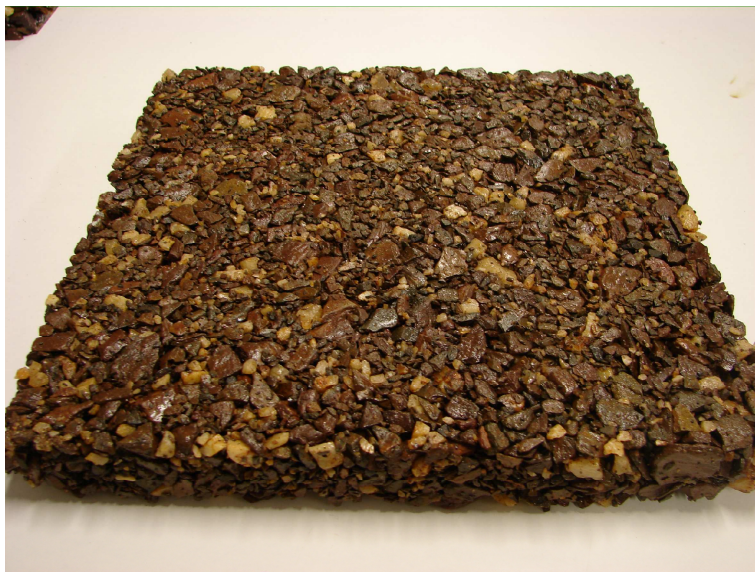
Figura 4.7: Provete composto por resíduos grossos e finos das escombreyras das Minas da Panasqueira e resina
