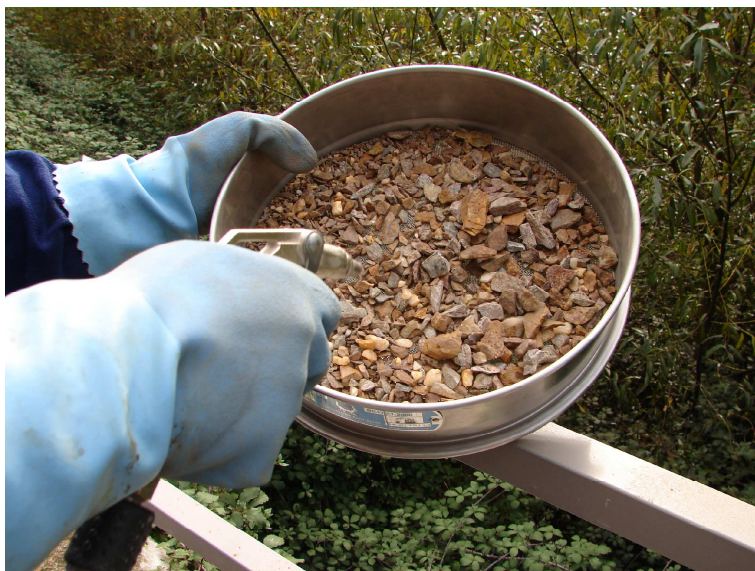
Figura 4.8: Limpeza de finos dos resíduos grossos com Compressor a Ar
