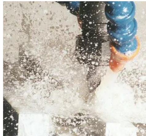
Figura 29 - Maquinagem com sistema de refrigeração abundante convencional. (Unist, n.d.)
