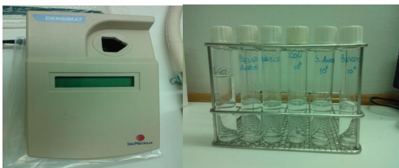
Figura 4.5 - Na esquerda fotómetro de medição da turvação pela escala McFarland para padronização de inóculos; na direita tubos com suspensões bacterianas.
