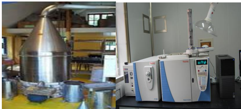
Figura 4.1 - Na esquerda extracção de óleos essenciais por arraste de vapor, na direita GC-ME [Adaptado de: http://aromalandia.com.br/extracao/html ; http://english.qibebt.cas.cn/rs/fs/ ].
