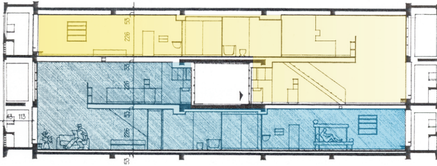
fig. 35 – corte pormenorizado da relação entre 2 apartamentos "duplex", (cada cor representa um apartamento individual)
