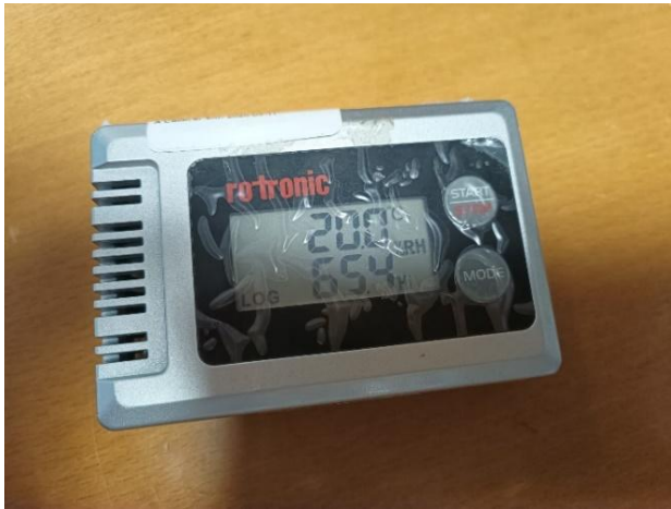
Anexo I - Termohigrómetro, para fazer o controlo da temperatura e humidade
