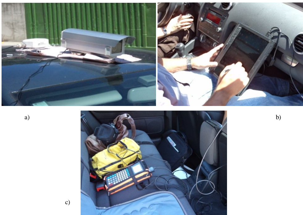
Figura 5 - Equipamento instalado na viatura (segunda campanha de levantamento) a) Câmara de vídeo e antenas de GPS; b) Computador portátil; c) Aquisição de posições: receptor GPS L1 , datalogger e bateria.
