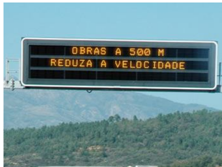
Figura 2 - Exemplo de painel de mensagem variável (PRP, 2011)
