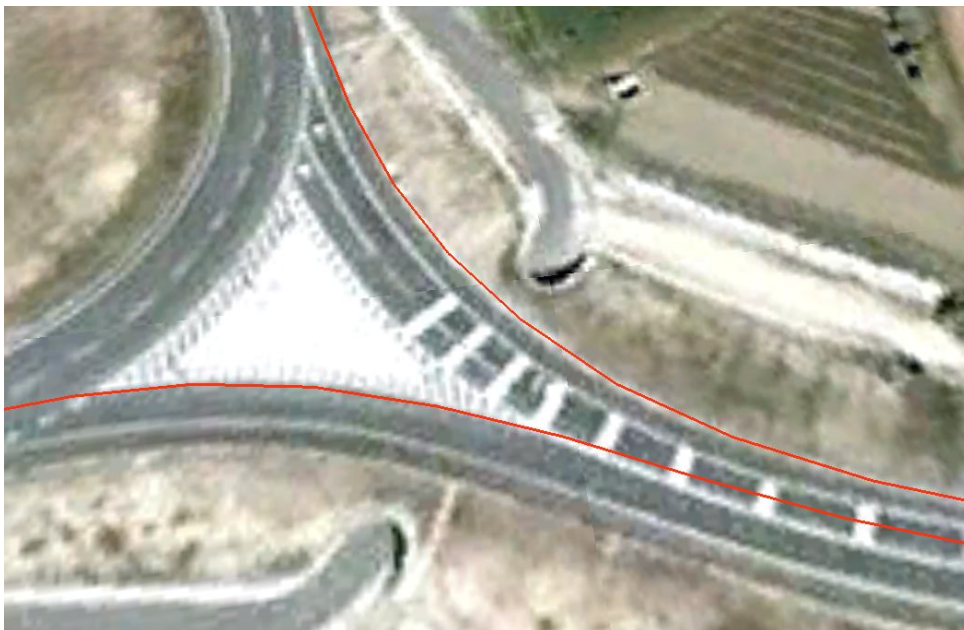
Figura 20 - Representação de um troço da rede rodoviária sobreposta à imagem raster disponível no Google Earth
