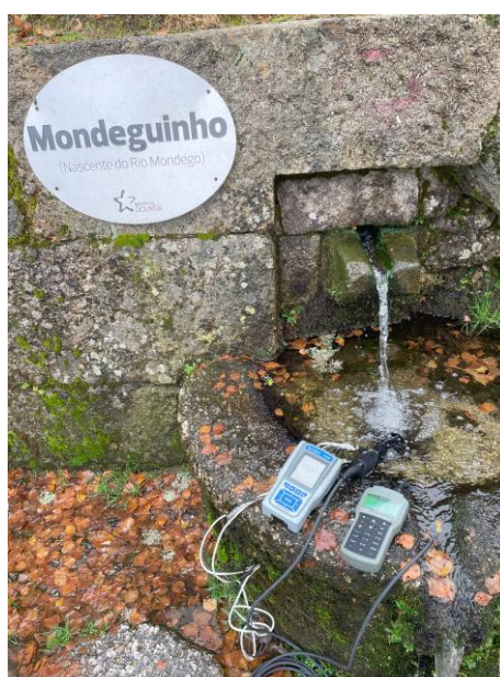
Figura 1.3 - Medidor paramétrico portátil de água (Eutech PC650) e medidor multiparâmetro portátil (Hanna HI98195), em fase de registos físico-químicos in situ .
