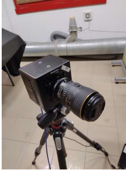
Figure 2.14: Photron FASTCAM mini UX 50 and Macro Lens Tokina AT-X AF PRO D.
