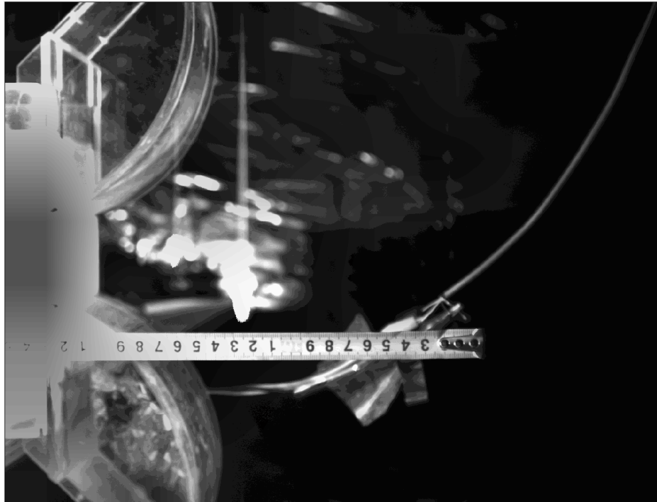
Figura 4.11: Exemplo de imagem de calibração. É ligado o laser de forma a identificar o plano de medição e a escala graduada em milímetros é colocada exatamente sobre esse plano.
