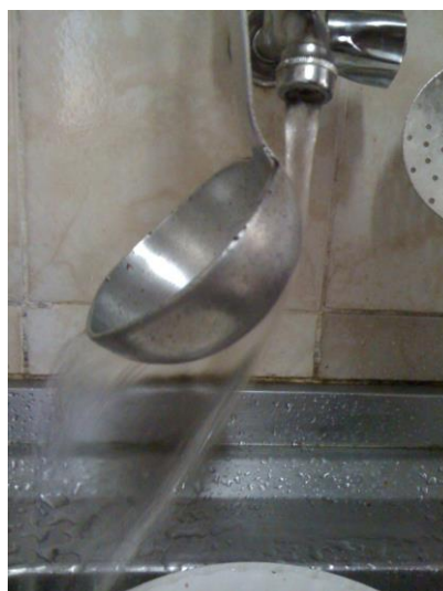
Figura 3.2: Demonstração do efeito Coanda [fonte: ftvieira.wordpress.com].
