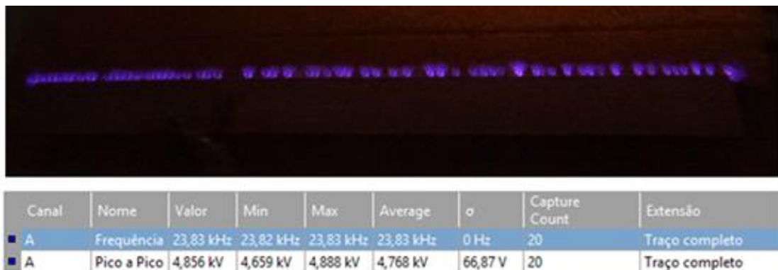
Figura 5.2: Atuador de Plasma de DBD alimentado a 4,8 kVpp e 23,8 kHz. Valores obtidos usando o PicoScope com uma precisão de \pm 0.001 kV e \pm 0.01 kHz.
