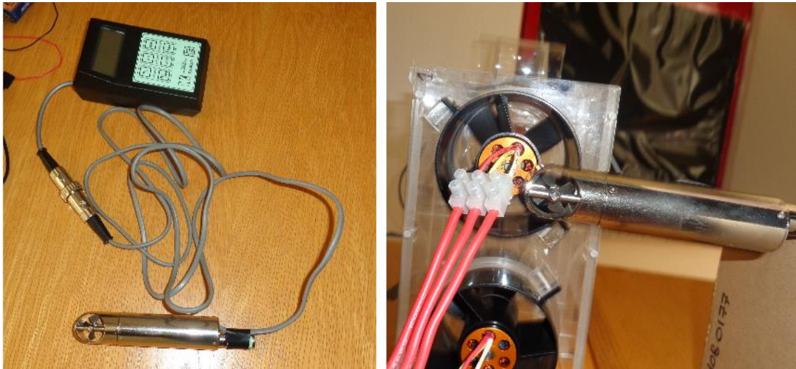
Figura 4.9: O anemómetro, de tipo molinete, montado e preparado para a realização das medições de velocidade do ar, selecionado para uma precisão de \pm 0.01 m/s (esquerda). Medição da velocidade do escoamento na zona de entrada do ar na tubeira (direita).
