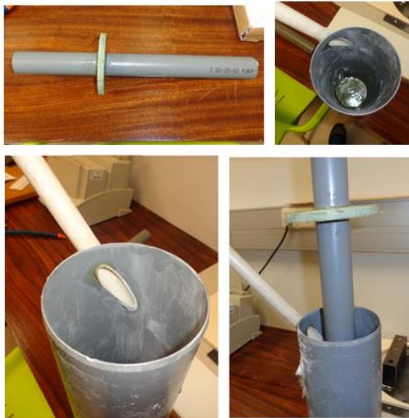
Figura 4.8: Diversas imagens recolhidas aquando da construção do ciclone, o qual funcionará como gerador de partículas sólidas.
