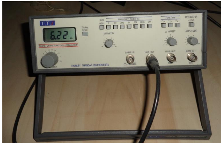
Figura 4.26: Gerador de sinais utilizado para iniciar a leitura de um par de imagens.
