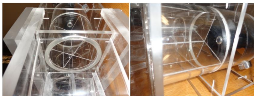
Figura 4.7: Alhetas finas em acrílico, com a forma de cruz, são introduzidas na entrada dos jatos produzidos pelos dois turbo-ventiladores. As suas dimensões foram estabelecidas de acordo com as sugestões apresentadas em Das et al. (2013).
