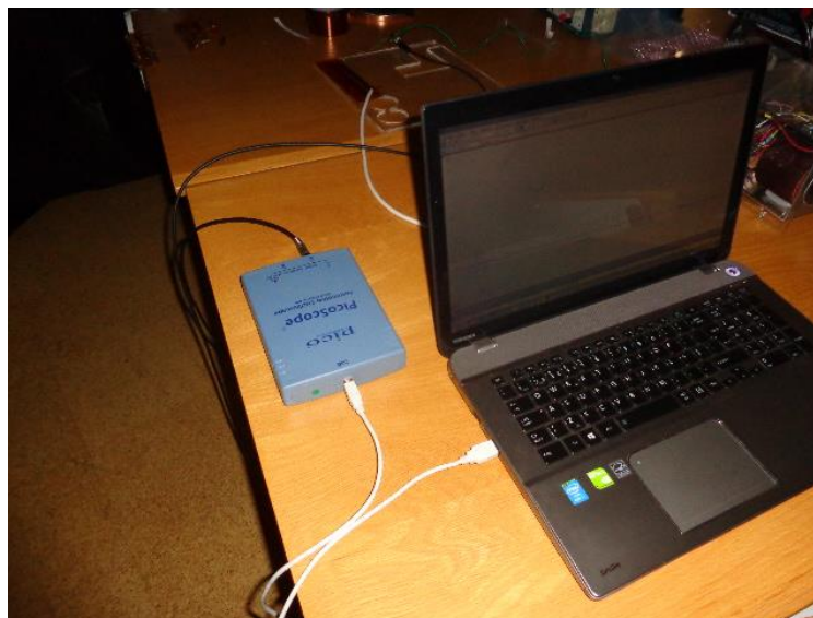
Figura 4.32: PicoScope ligado ao computador para medição da tensão de alimentação de um atuador de plasma DBD.
