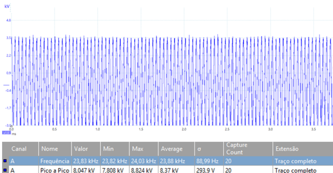
Figura 5.1: Forma de onda e medição da tensão, e da frequência, para atuador a plasma feito com fita de cobre e fita de kapton (500 \mu s/div)
