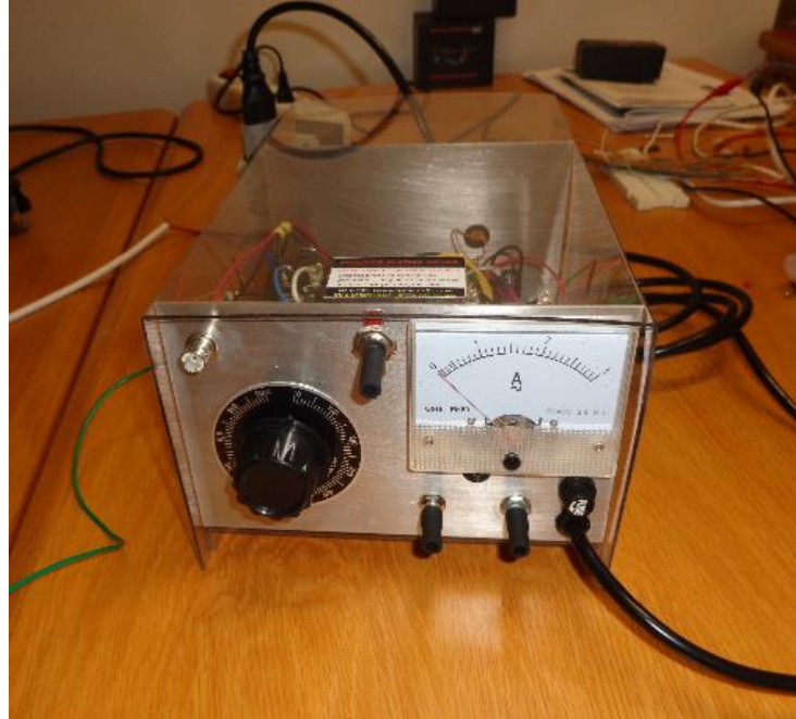
Figura 4.31: Fonte de alimentação PVM500 de alta tensão, e alta frequência, utilizada para alimentar os atuadores a plasma de tipo DBD.
