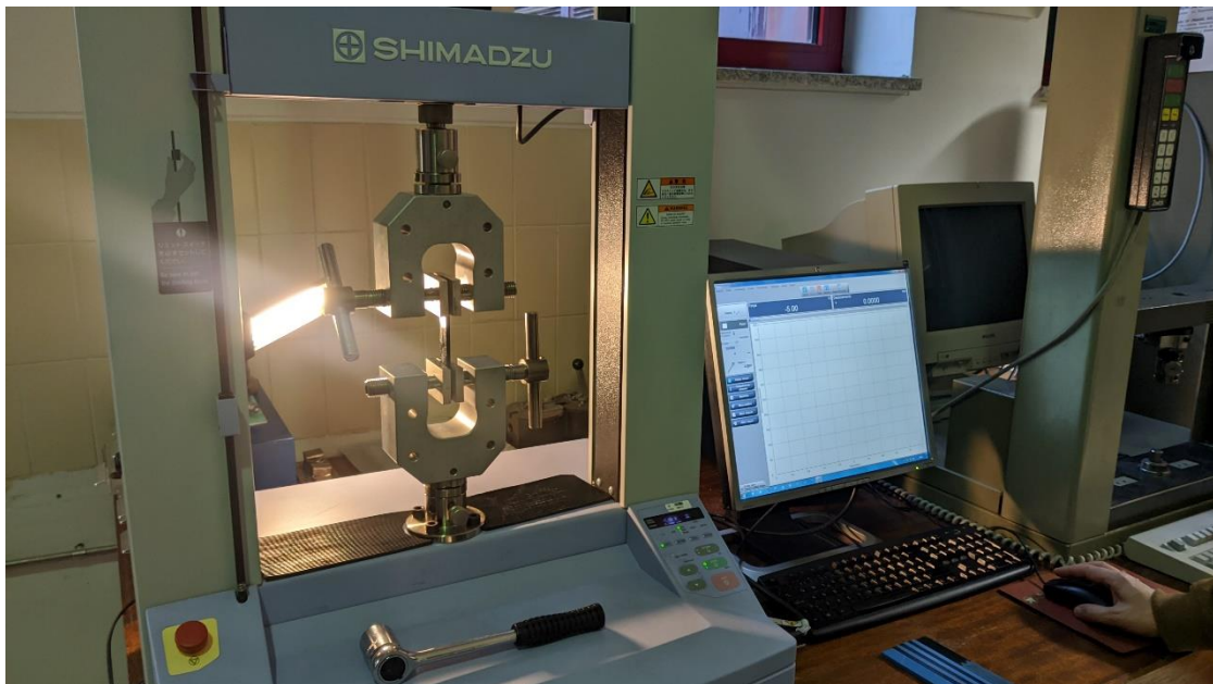
Figura 66 – Máquina utilizada para realizar testes de tração, Shimadzu AGS-X 10KN .
