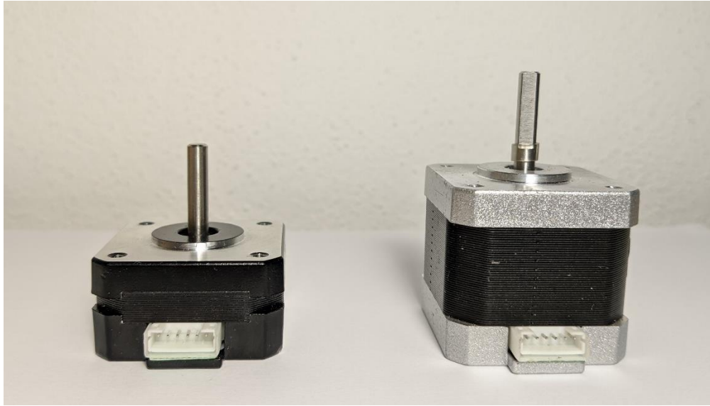
Figura 29 – Motores de passo adquiridos: Nema 17 42 – 23 mm à esquerda; Nema 17 42 – 40 mm à direita
