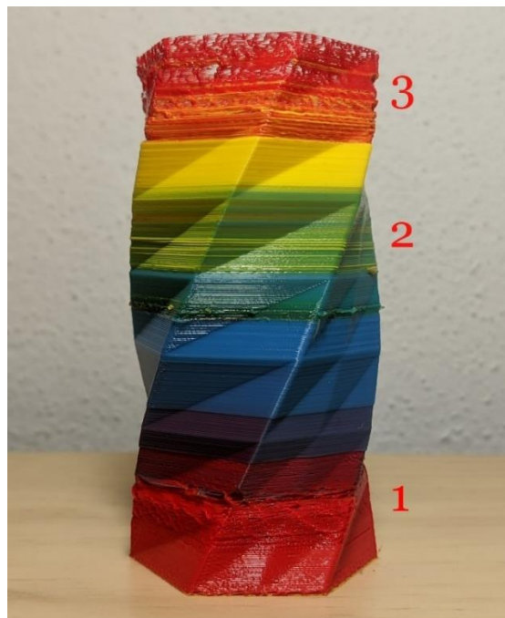
Figura 81 – Resultado do teste de impressão multicolor (mistura de filamentos).
