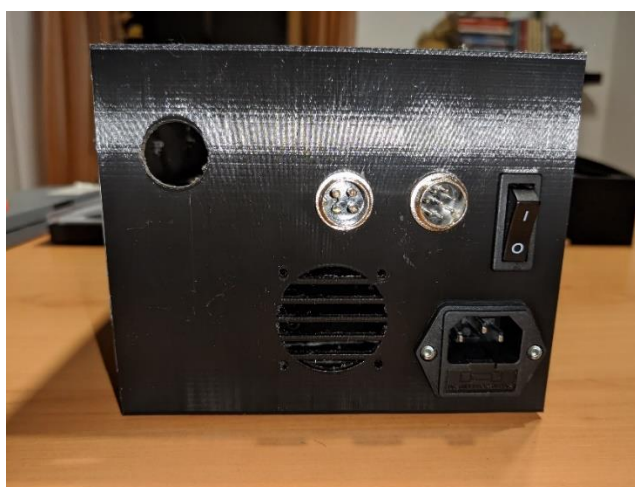
Figura 84 – Acoplamento da ficha IEC 3P, do interruptor e dos conectores.
