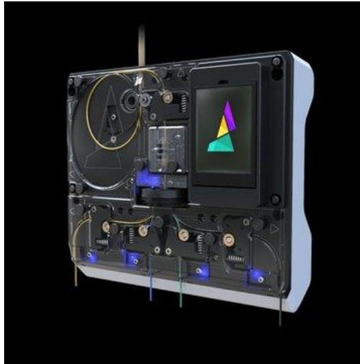
Figura 14 – Pallette 2: vista interior dos diversos componentes [27].
