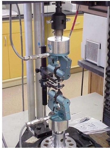
Figura 2 – Equipamento utilizado na medição da resistência á tracção (ver anexo).
