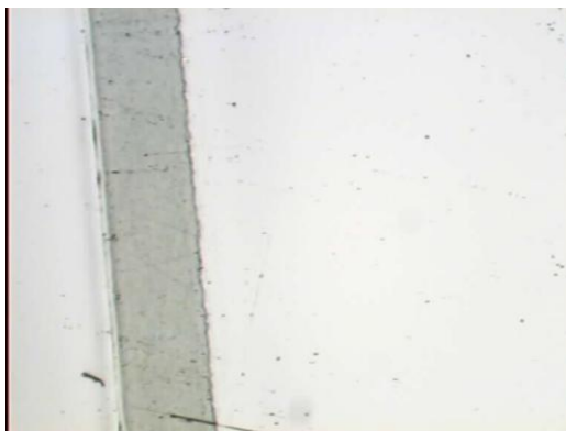
Figura 25 – Corte transversal do filme da amostra 9.
