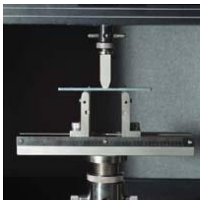
Figura 3 – Equipamento usado para ensaio da resistência á flexão (ver anexo).
