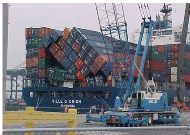
Figura 1.2 - Derrube de contentores empilhados em navios porta-contentores [7]
