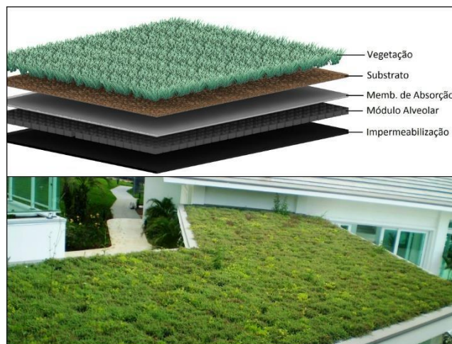
Figura 27- Cobertura Verde (Engenharia360, 2020)
