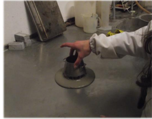
Figura 3.13. 3ª Fase do ensaio de espalhamento
