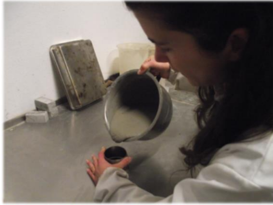
Figura 3.12. 2ª Fase do ensaio de espalhamento
