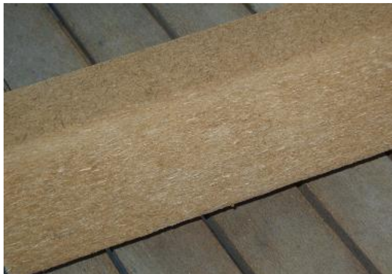
Fig. 18 - Foto de um painel de MDF com uma densidade de 250 \text{ kg/m}^3 - fabricante Glunz
