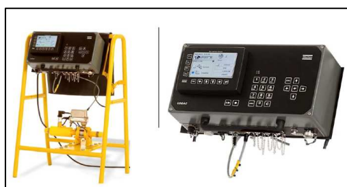
Figura 2-22 - Equipamento eletrônico de monitorização de dados de Lugeon e Grouting (Quinones-Rozo, 2010).
