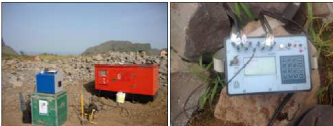
Figura 3-18 Aspeto da fonte de injeção VIP 10 000 (esquerda) e Elrec Pro (direita) (MEECFG, 2012).
