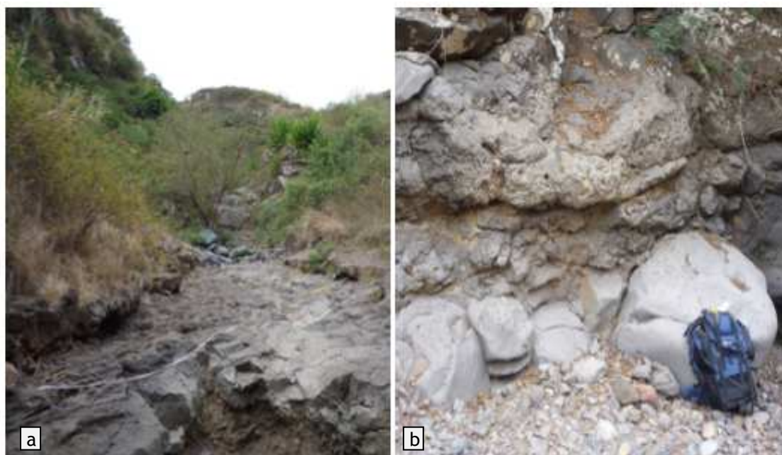
Figura 3-16 Aspeto dos depósitos conglomeráticos 15m a montante (a) e 15m a jusante (b) da implantação da barragem (MEECFG, 2012).
