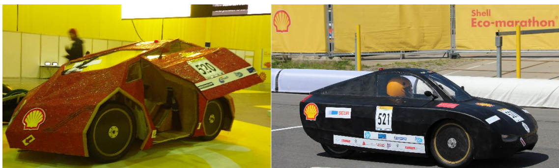
Figura 1.1 - Veículos Automóveis desenvolvidos pela UBI para competição Shell Eco-marathon com revestimentos irregulares para redução de atrito aerodinâmico.
