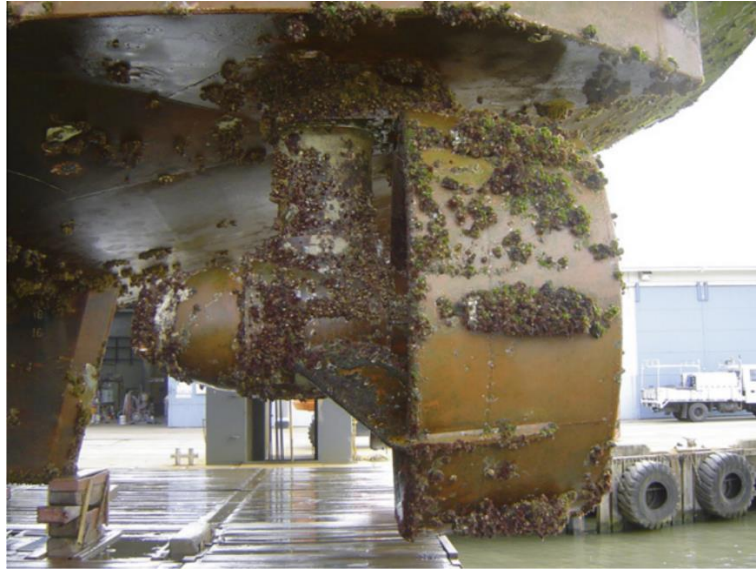
Figura 1.6 - Casco de navio encrostado que apresenta encostamento de organismos que crescem nas partes exteriores submersas, Foto: J. Lewis [16].
