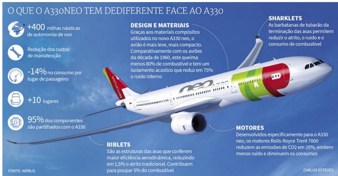
Figura 1.4 - Avião da companhia aérea comercial TAP com utilizações de Riblets para a redução de atrito aerodinâmico [15].
