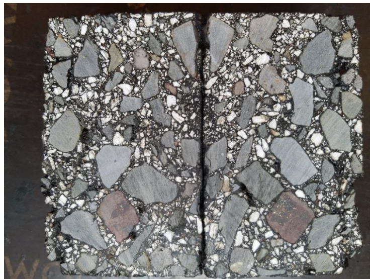
Figura 3.1 – Corte de Marshal com agregados grossos flutuantes visíveis
