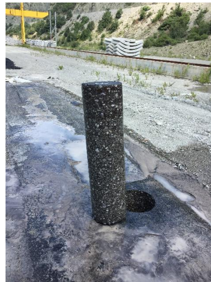
Figura 4.15 - Extração de carotes no trecho experimental com máquina
