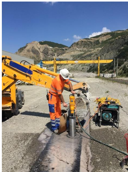
Figura 4.15 - Extração de carotes no trecho experimental com máquina
