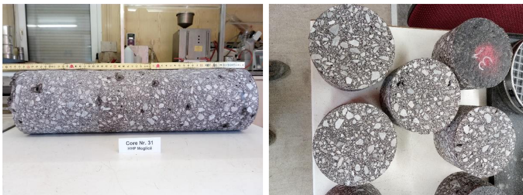
Figura 4.34 - Carotes do núcleo e provetes
