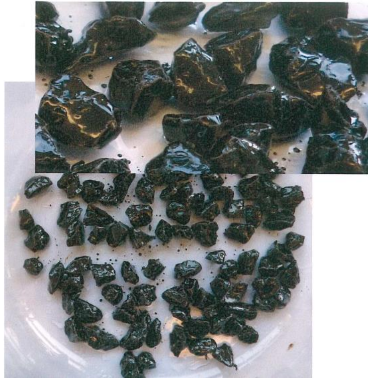
Figura 4.4 - Grau de recobrimento dos agregados
