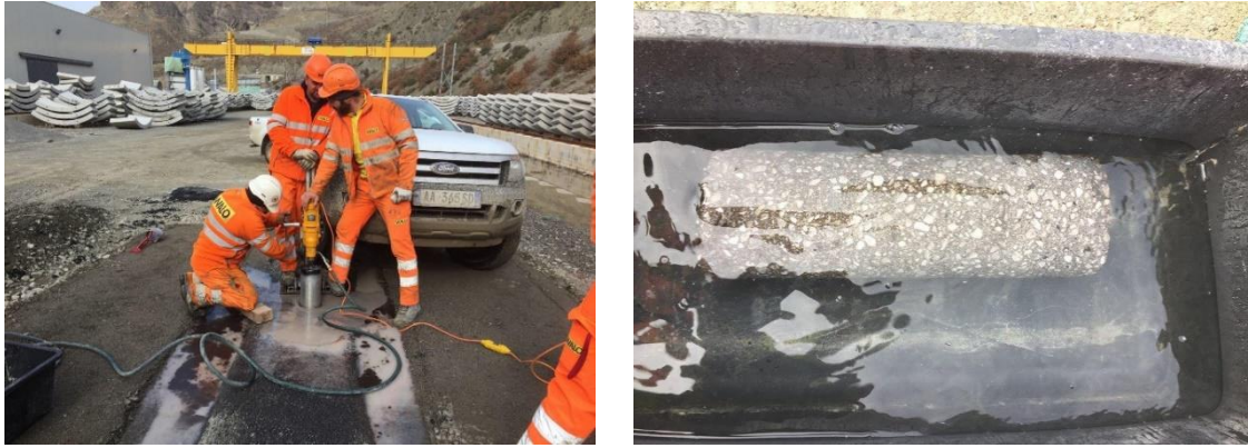
Figura 4.10 - Extração de carotes no trecho experimental à mão
