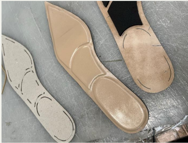
Figura 45: Etapas de montagem da palmilha. (A autora, 2022)
