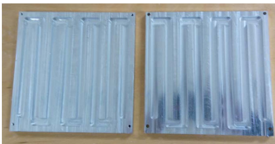
Figura 3.6: Placas do permutador de calor depois do processo de maquinação realizado.
