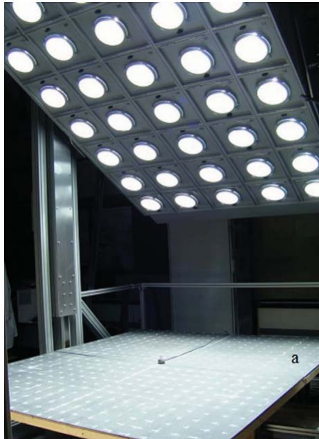
Figura 2.15: Exemplo de um simulador solar composto por lâmpadas de iodetos metálicos (adaptado de [67]).
