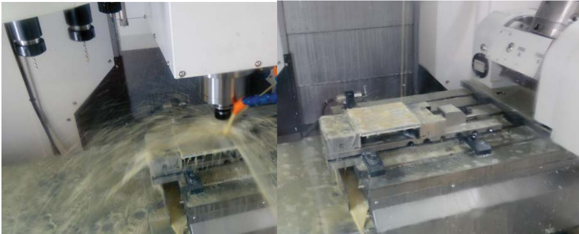
Figura 3.7: Processo de maquinação das placas de alumínio na máquina CNC do FABLAB-UBI.
