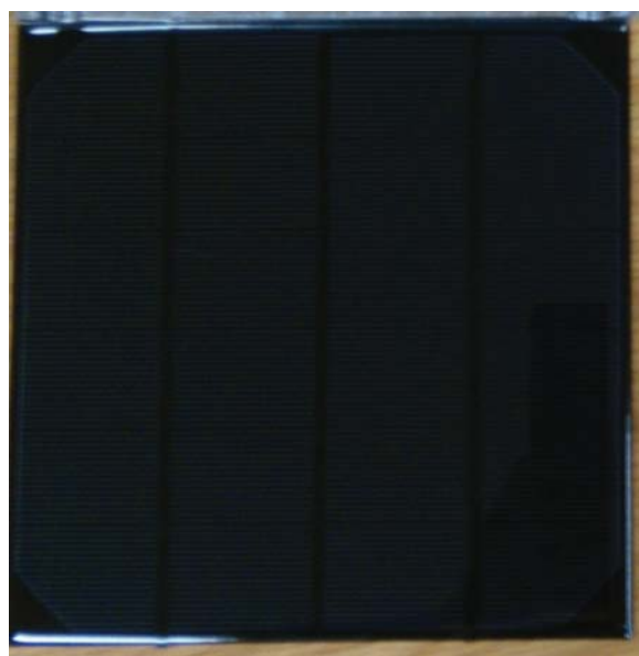
Figura 3.1: Painel fotovoltaico adquirido. Pormenor das três linhas de descontinuidade fotovoltaica.
