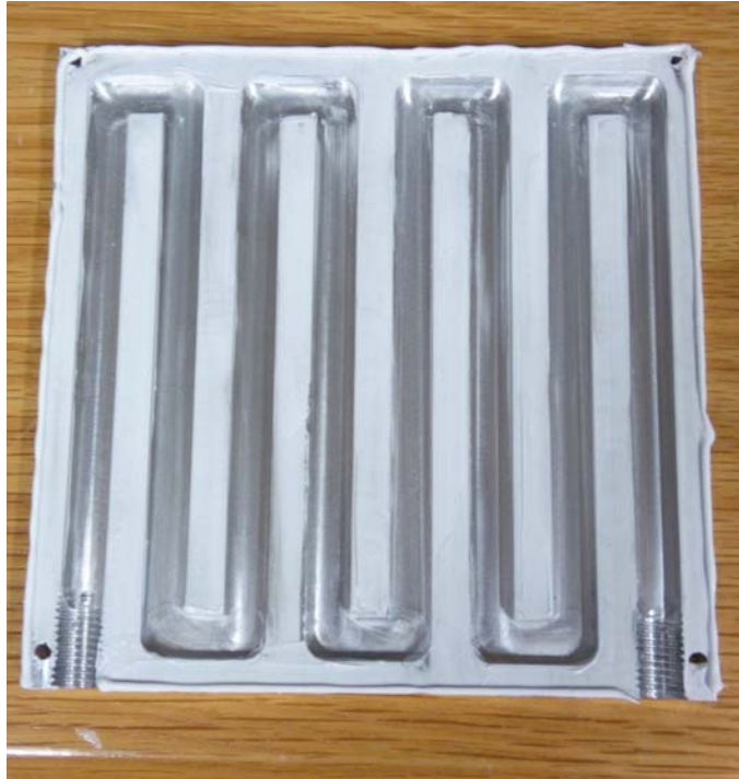
Figura 3.8: Detalha da camada de vedante aplicado sobre uma das placas do permutador de calor.
