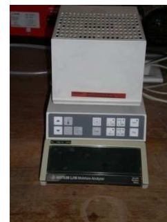
Figura 12: Balança com infravermelhos para determinação do teor de matéria seca.
