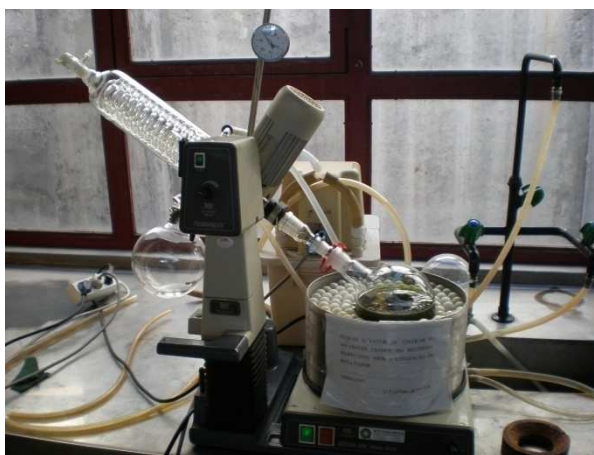
Figura 15: Evaporador rotativo utilizado durante as sucessivas determinações.
