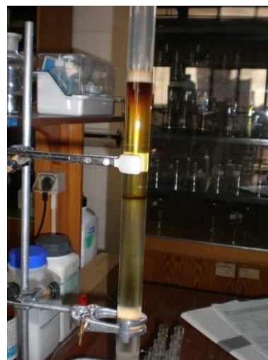
Figura 20: Montagem laboratorial de uma coluna de cromatografia.
