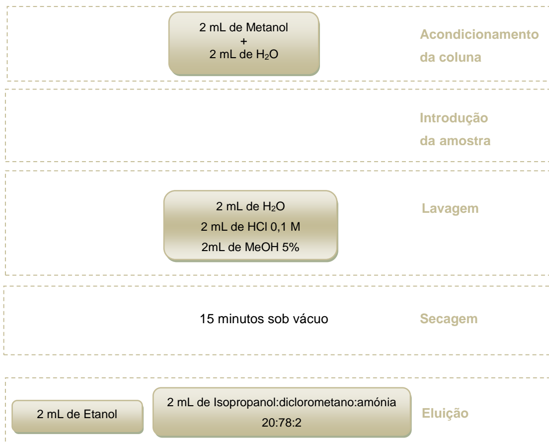
Figura 27. Esquematização dos procedimentos SPE de acondicionamento da coluna, lavagem, secagem e eluição utilizando colunas Oasis ® MCX.
