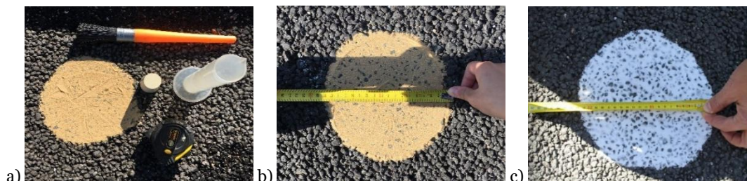
Figura 5.29 Técnica volumétrica da mancha: a) Material; b) Com areia; c) Com esferas de vidro
