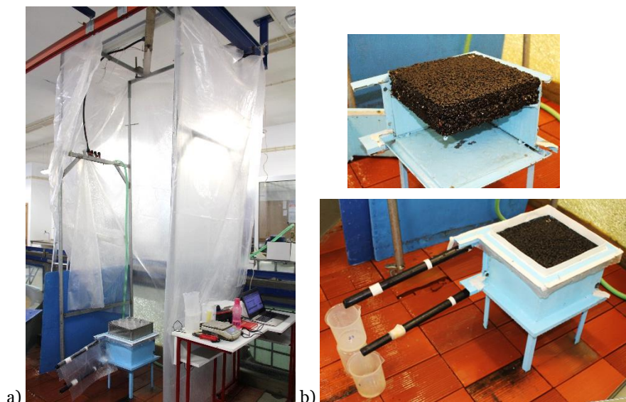
Figura 4.19 Ensaio de simulação da precipitação: a) Simulador de chuva b) Estrutura modular de suporte da DLPA
