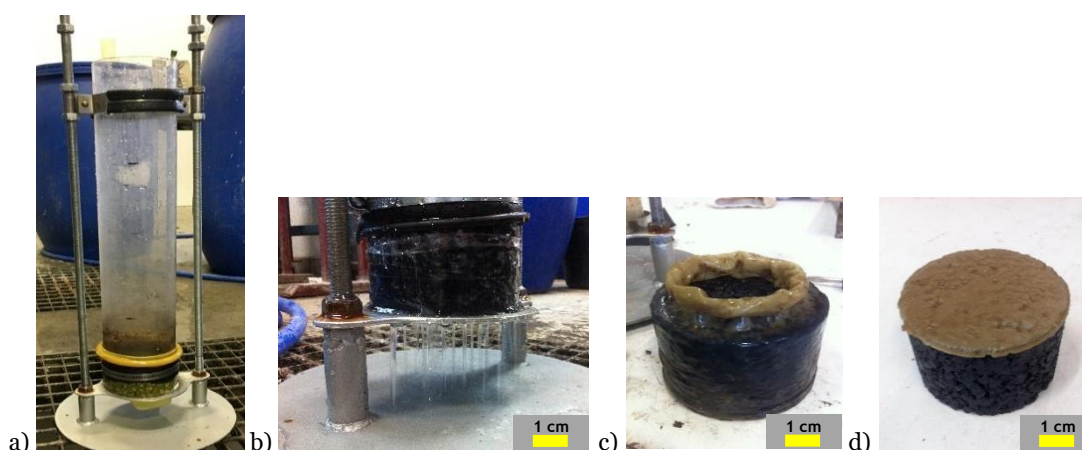
Figura 4.15 Ensaio de permeabilidade em laboratório: a) Permeâmetro; b) Exemplo de ensaio a decorrer; c) Provette a ensaiar na direção vertical; d) Provette a ensaiar na direção horizontal
