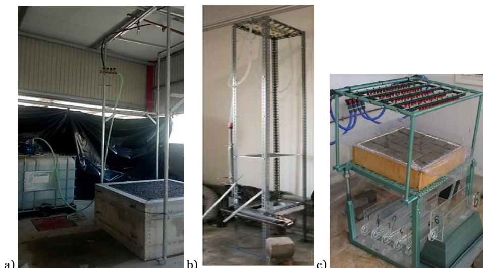
Figura 3.3 Simuladores de chuva desenvolvidos por: a) Carvalho (2015); b) Andrés-Valeri et al. (2016); c) Hernández (2008)
