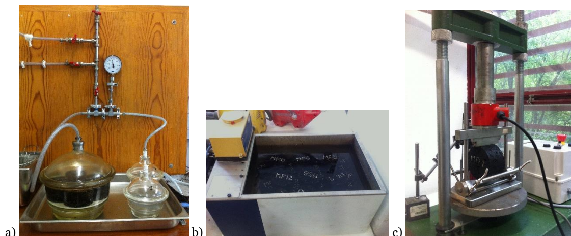
Figura 3.1 Equipamentos do ensaio de sensibilidade à água: a) Vácuo; b) Banho de água; c) Ensaio de tração indireta em compressão diametral
