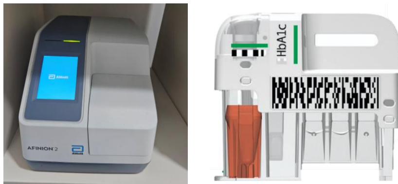
Figura 5 - À esquerda encontra-se o equipamento Afinion 2 e à direita encontra-se o painel de HbA1c Afinion [22]
