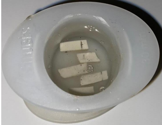
Figura 11- Amostra após o polimento preparada para ensaio de dureza
