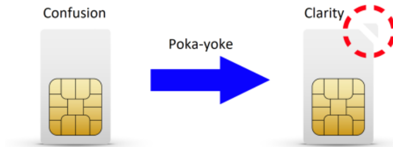
Figura 2.7: Exemplo da aplicação do POKE-YOKE
