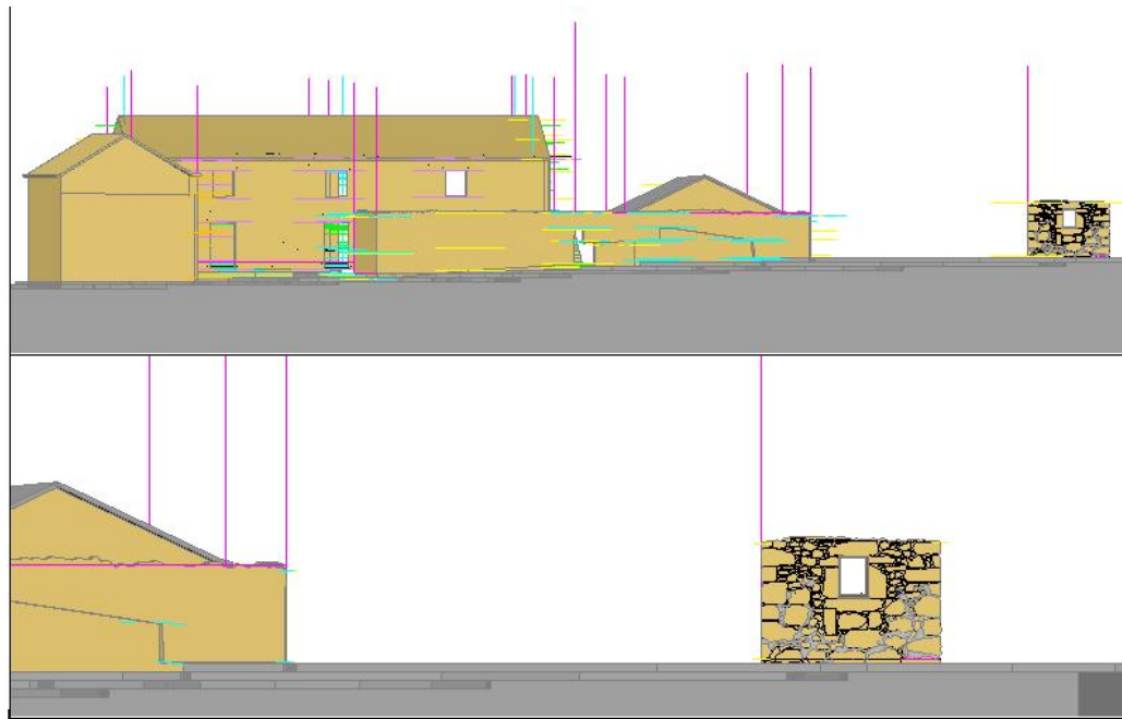
Figura 140 - Alçado da parede ED04 do edifício 255362QtSeves_ED04 com indicação da cota altimétrica Inserido no modelo tridimensional do conjunto
