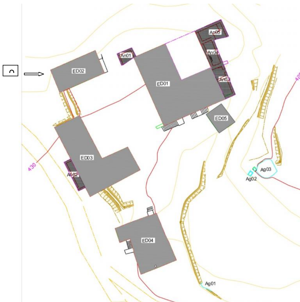
Figura 124 - Esquema identificador dos elementos principais do conjunto a levantar com indicação do ponto Ox.
