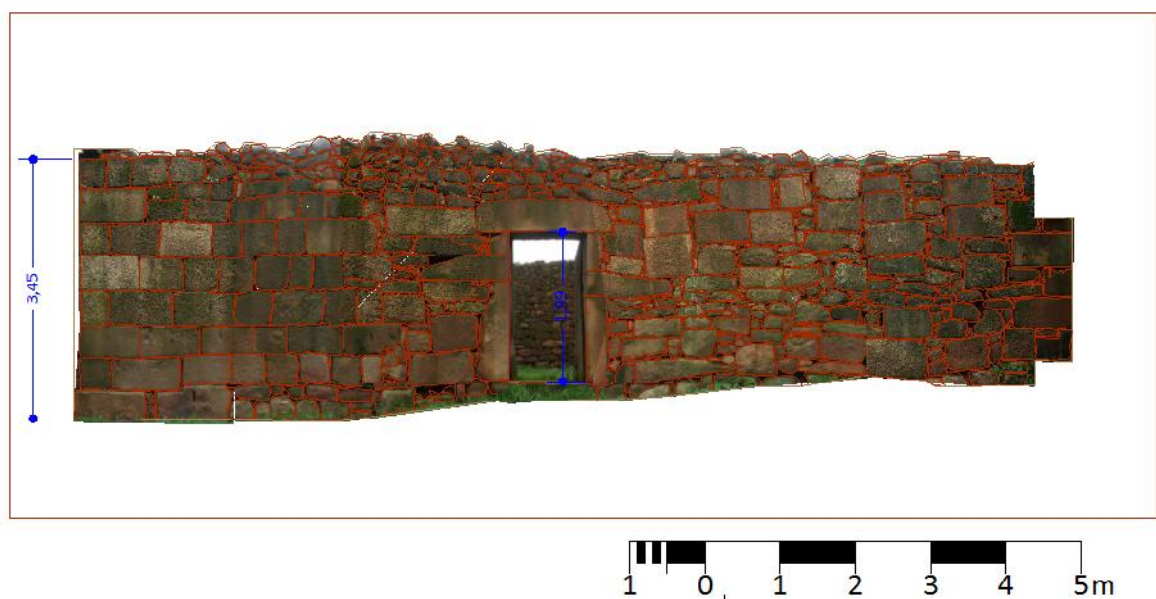
Figura 59 - Sobreposição do fotomosaico e do alçado base da capela da tapada de São Pedro, Capinha, Fundão
