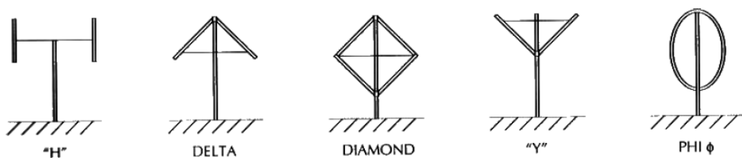
Figura 2.11 - Configurações alternativas do rotor da turbina Darrieus. Fonte: Gipe, 2004
