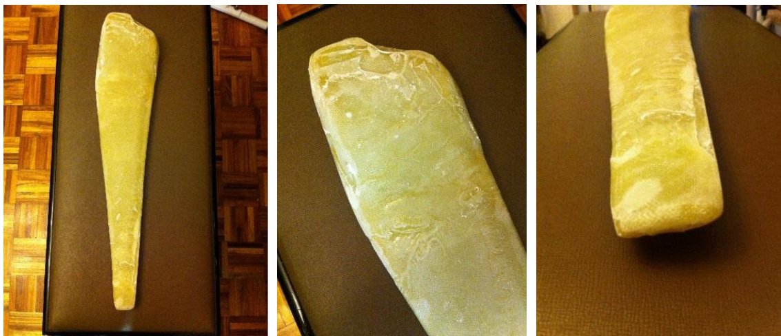
Figura 3.46 - Aspeto final da pá construída.
