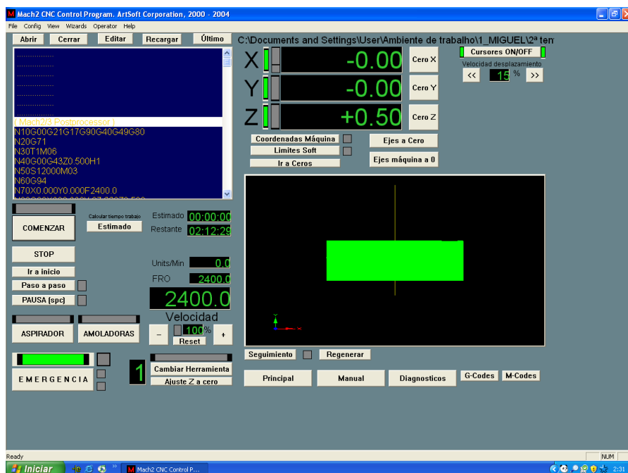
Figura 3.40 - Interface gráfica do programa Mach 2 depois de percorridas as linhas de corte.
