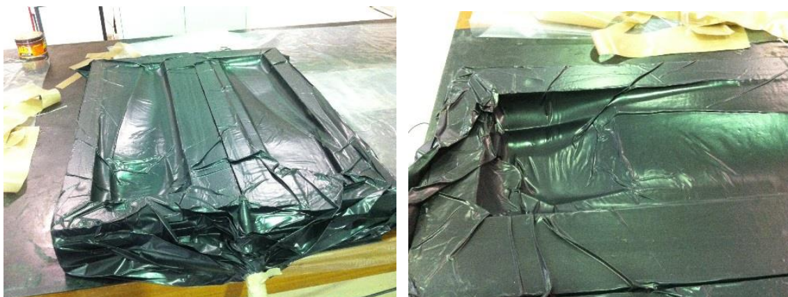
Figura 3.44 - Saco de vácuo com as duas partes do molde no interior.
